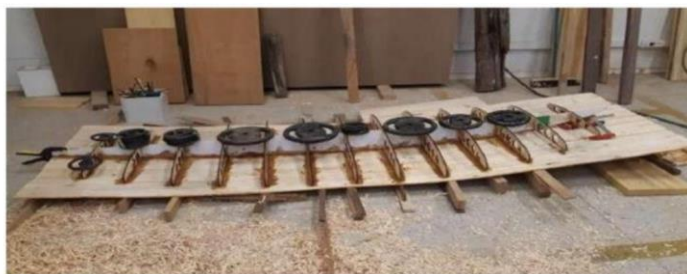
Figura 16: Colagem da estrutura interna ao rocker
