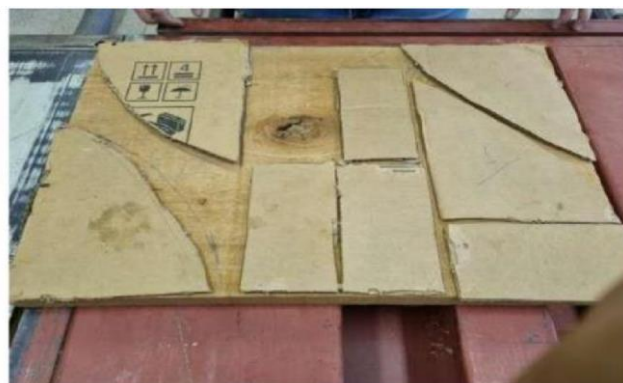
Figura 18: Marcação com gabarito de papelão
