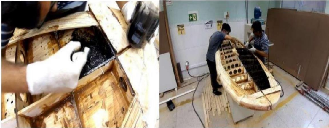
Figura 23: Isolamento com resina epóxi na parte interna e no outline da prancha Fonte:
