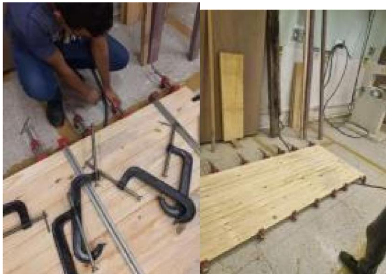
Figura 10: Colagem das peças
