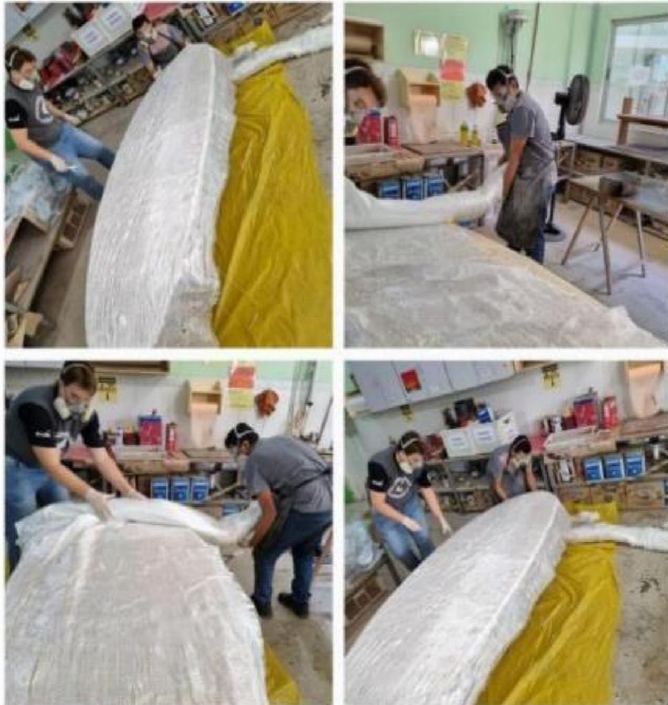
Figura 27: Laminação com manta de fibra de vidro
