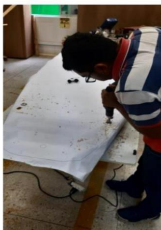
Figura 29: Furação para a instalação dos acessórios handler , quilhas e leash
