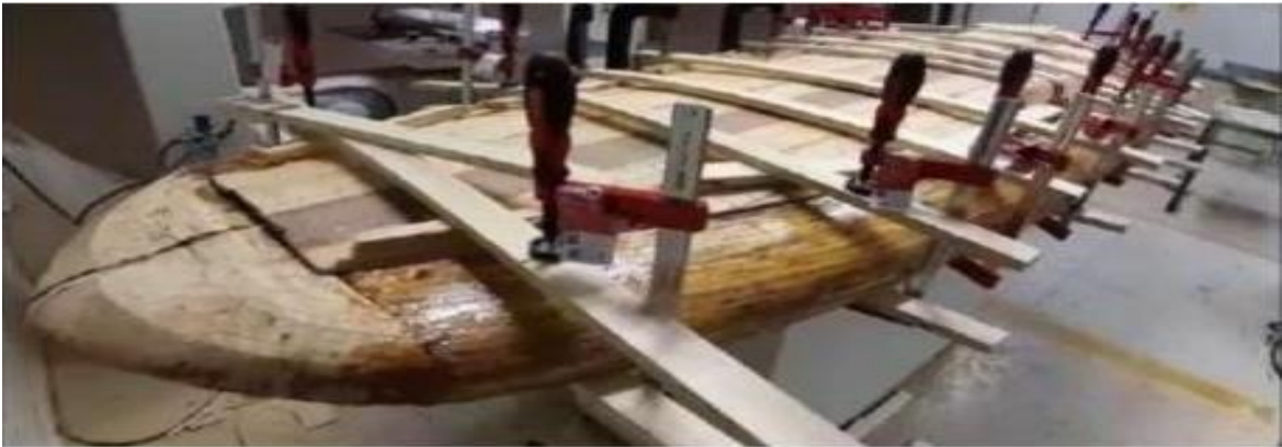
Figura 25: Colagem do deck com a prancha
