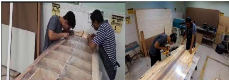
Figura 24: Montagem do deck na prancha de SUP
