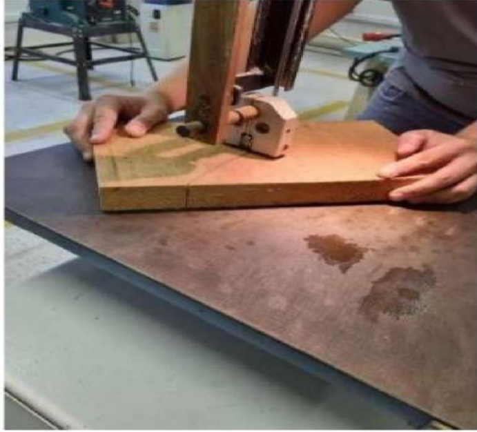
Figura 19: Corte das peças de reforço
