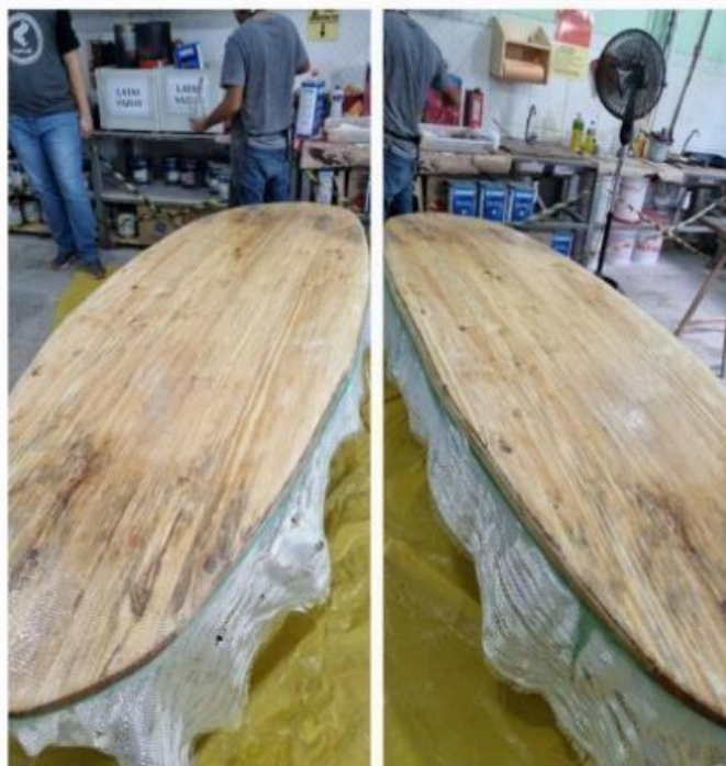
Figura 28: Laminação com manta de fibra de vidro sobre a prancha de madeira
