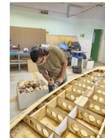
Figura 22: Processo de retirar as imperfeições do outline com a esmerilhadeira
