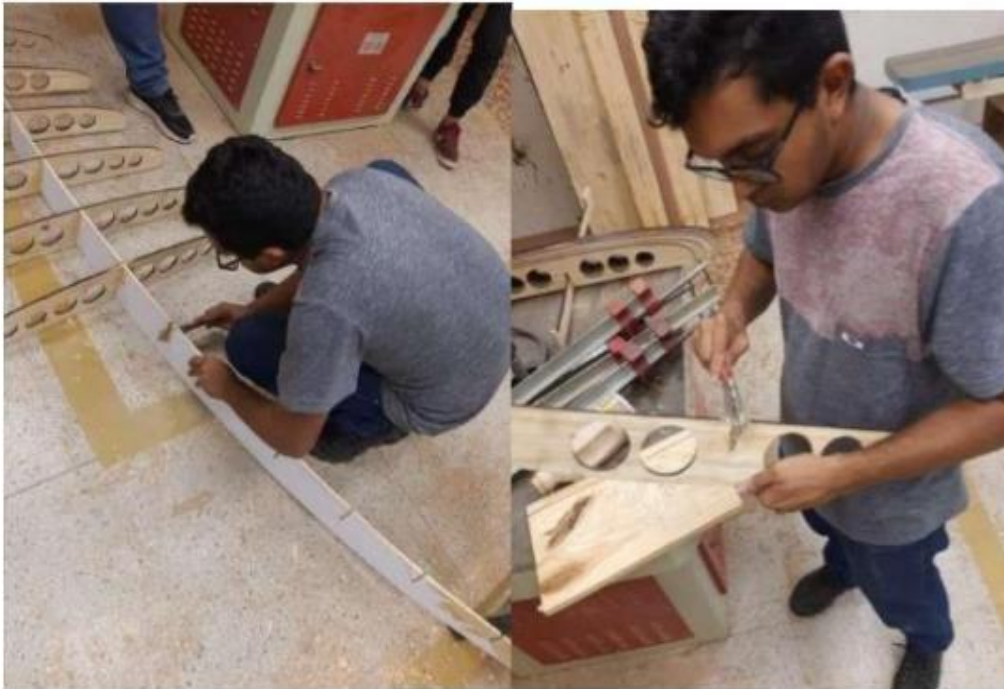
Figura 15: Colagem das peças para formação da estrutura interna
