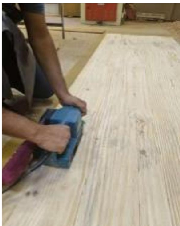
Figura 11: Lixamento do Rocker
