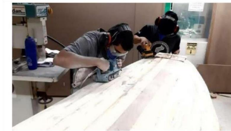
Figura 26: Preparação com lixamento para a aplicação da fibra de vidro
