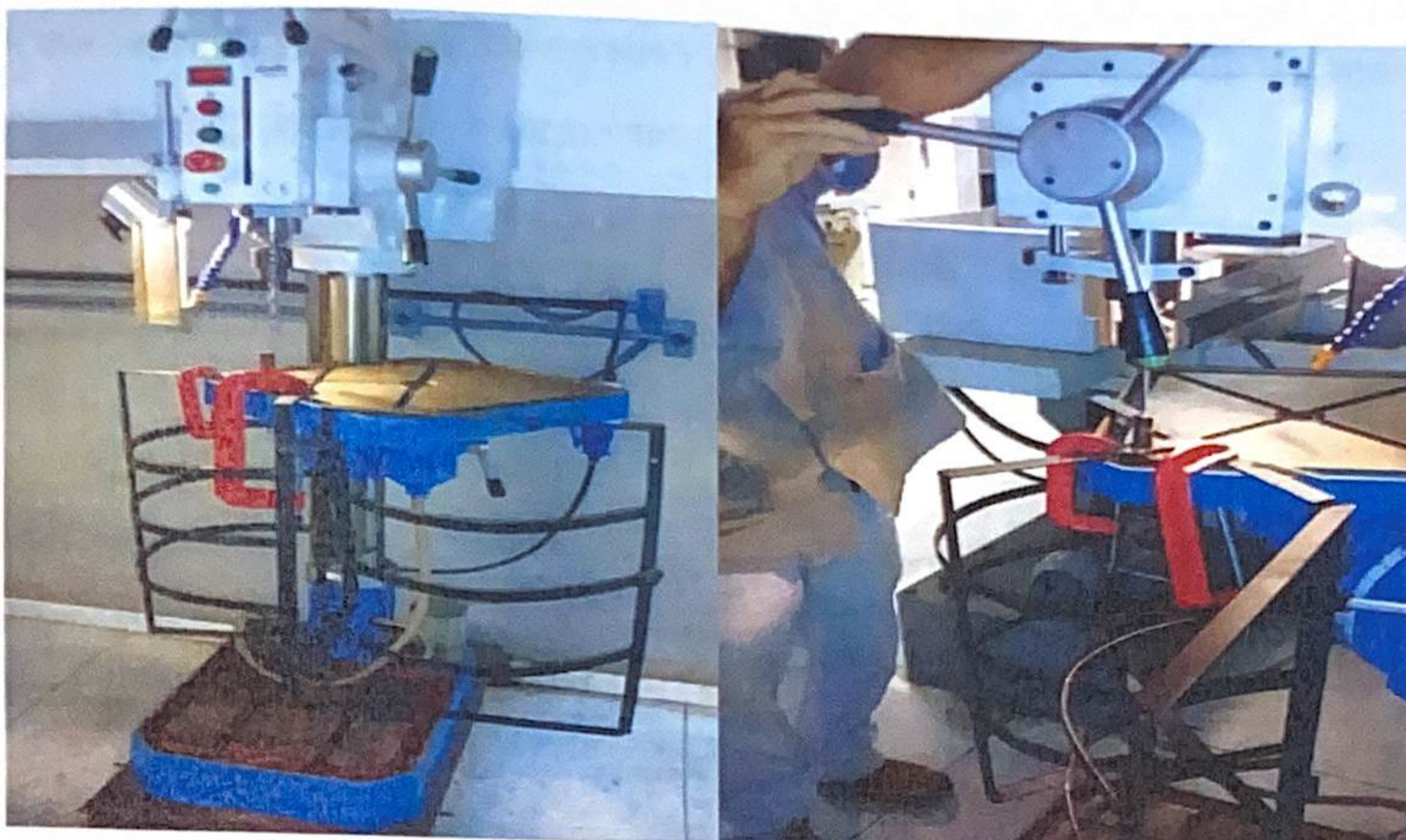
Figura 25 e 26 - Realização do furo de eixo para a passagem do fio do termostato. Máquina utilizada: Furadeira de bancada industrial. Fonte: acervo autor.
