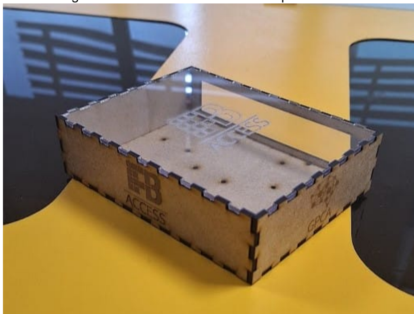
Figura 34 – Invólucro em MDF e tampa de acrílico
