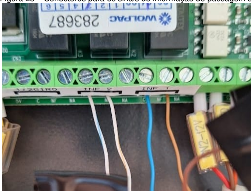
Figura 25 – Conectores para os sinais de informação de passagem 5v
