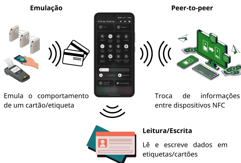
Figura 6 – Modos de funcionamento do NFC
