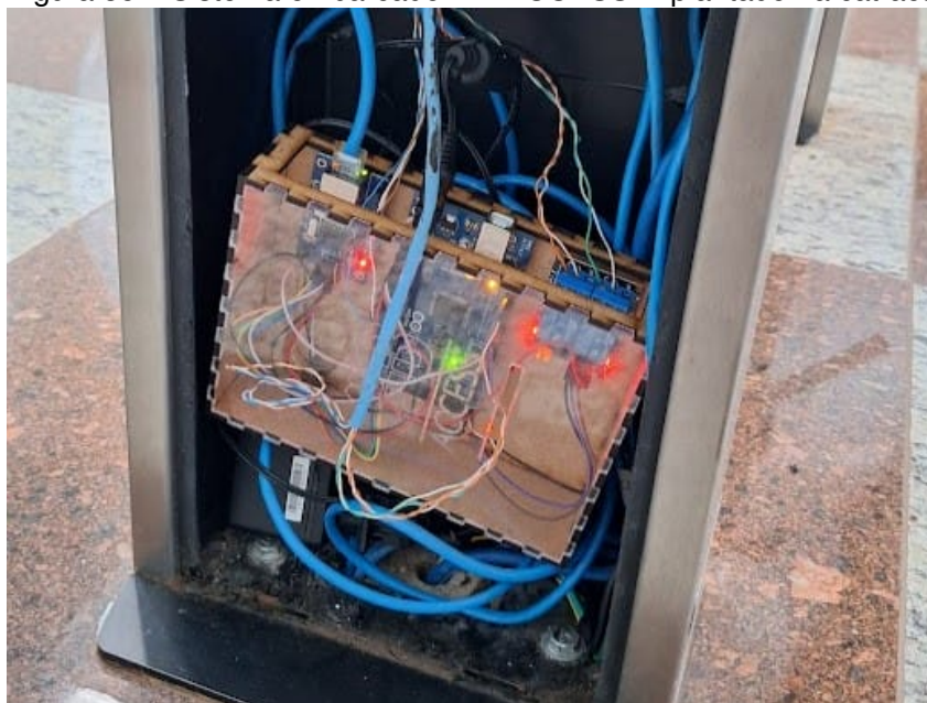
Figura 35 – Sistema embarcado IFB ACCESS implantado na catraca
