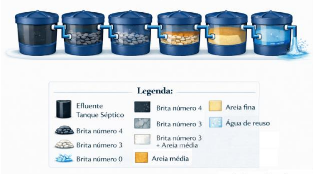
Figura 1. Esquema ilustrativo do sistema de desinfecção da ETE ReAqua – Embrapa Hortaliças (DF)
