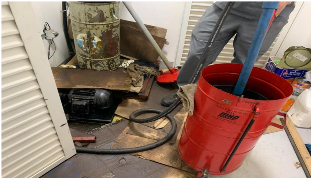
Figura 6 — Sucção do OLUC no carrinho coletor (concessionária ORCA)
