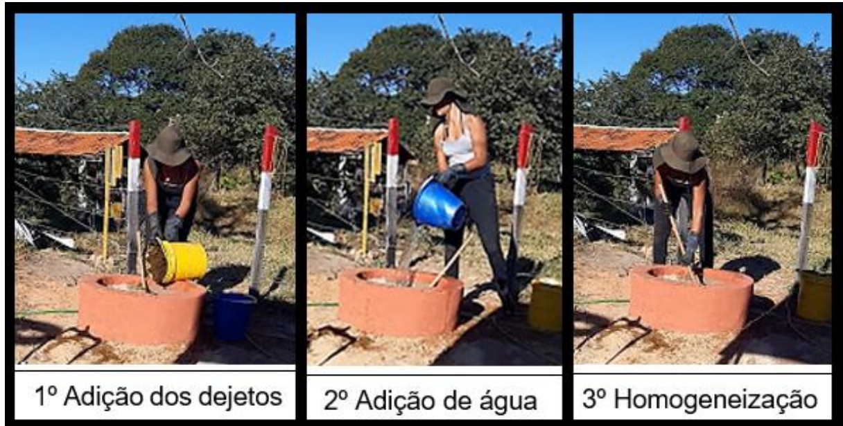
Figura 12: Abastecimento do biodigestor
