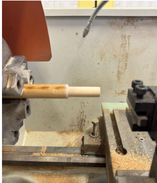
Figura 7: Usinagem do protótipo, com madeira pinus peça base.
