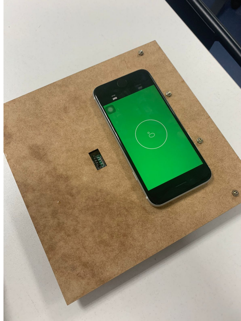
Figura 5.11 Placa de madeira base da balança
