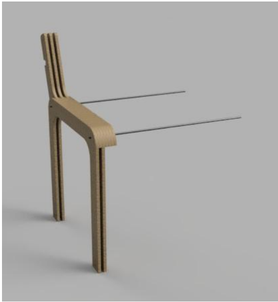
Figura 17 - Montagem da lateral.
