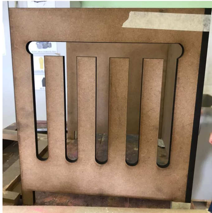
Figura 29 - Jogo de encaixes cortado a laser
