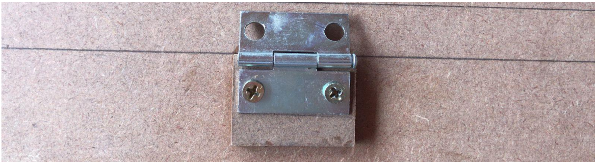
Figura 37 – Colocação da dobradiça
