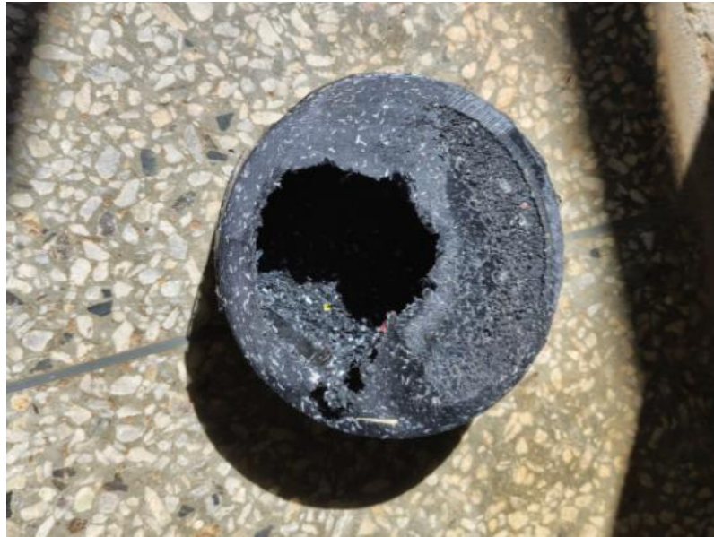
Figura 4: Primeiro tratamento (peça incompleta)
