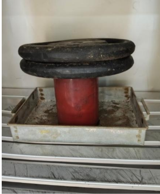
Figura 5: Pesos sobre o círculo de madeira
