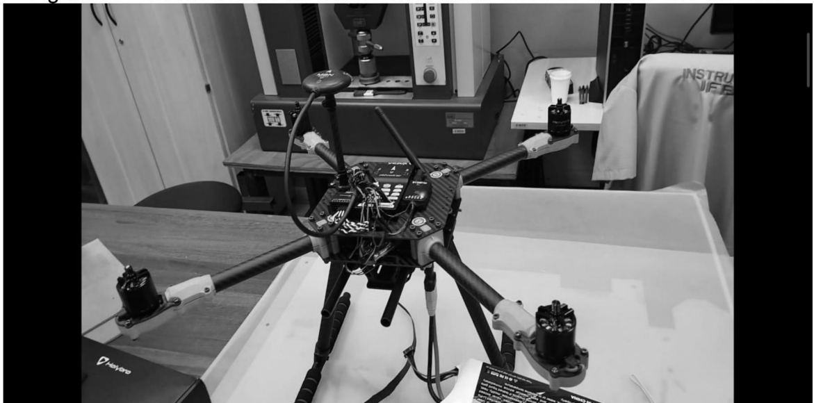
Figura 18 - Drone básico montado em meio de teste de sentido dos motores
