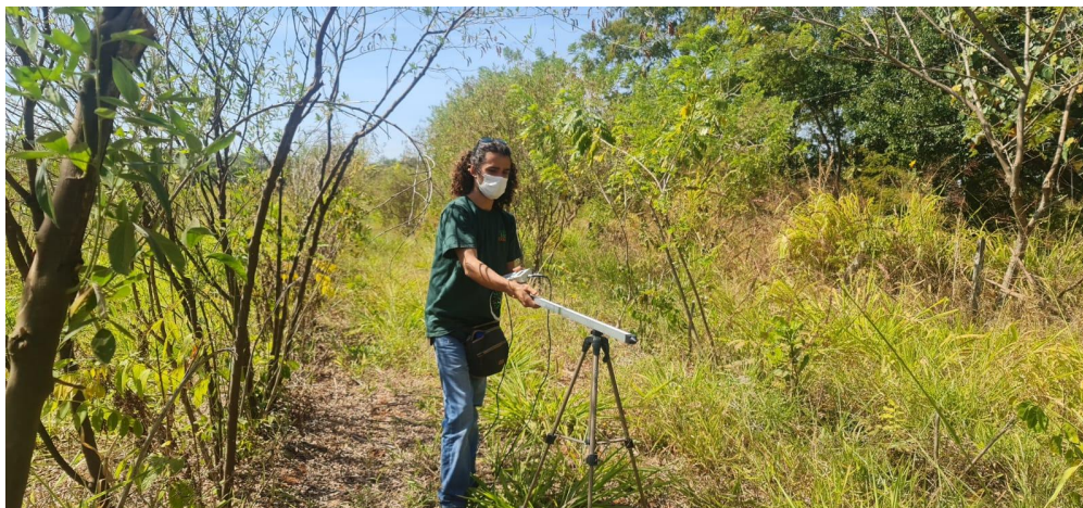
Figura 15: mensuração da RFA com o uso do sensor Line Quantum Sensor – LICOR.
