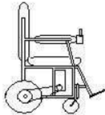
Figura 2.1: Um dos primeiros protótipos de cadeira de rodas patenteados com joystick utilizando transmissão por corrente
