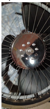
Figura 3.2: Engrenagem para corrente com diâmetro de 180 mm
