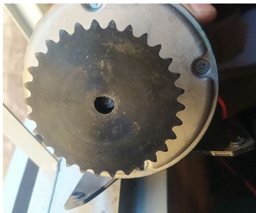
Figura 3.3: Engrenagem para corrente com diâmetro de 63.5 mm
