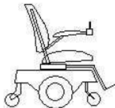
Figura 2.3: Sistema motorreductor direto nas rodas de tração com melhorias estéticas, ergonômicas e aumento do número de rodas de estabilidade
