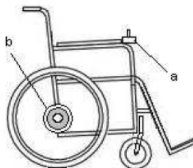
Figura 2.7: Motor acoplado no eixo na roda, (a) - joystick , (b) - Motor acoplado no eixo roda
