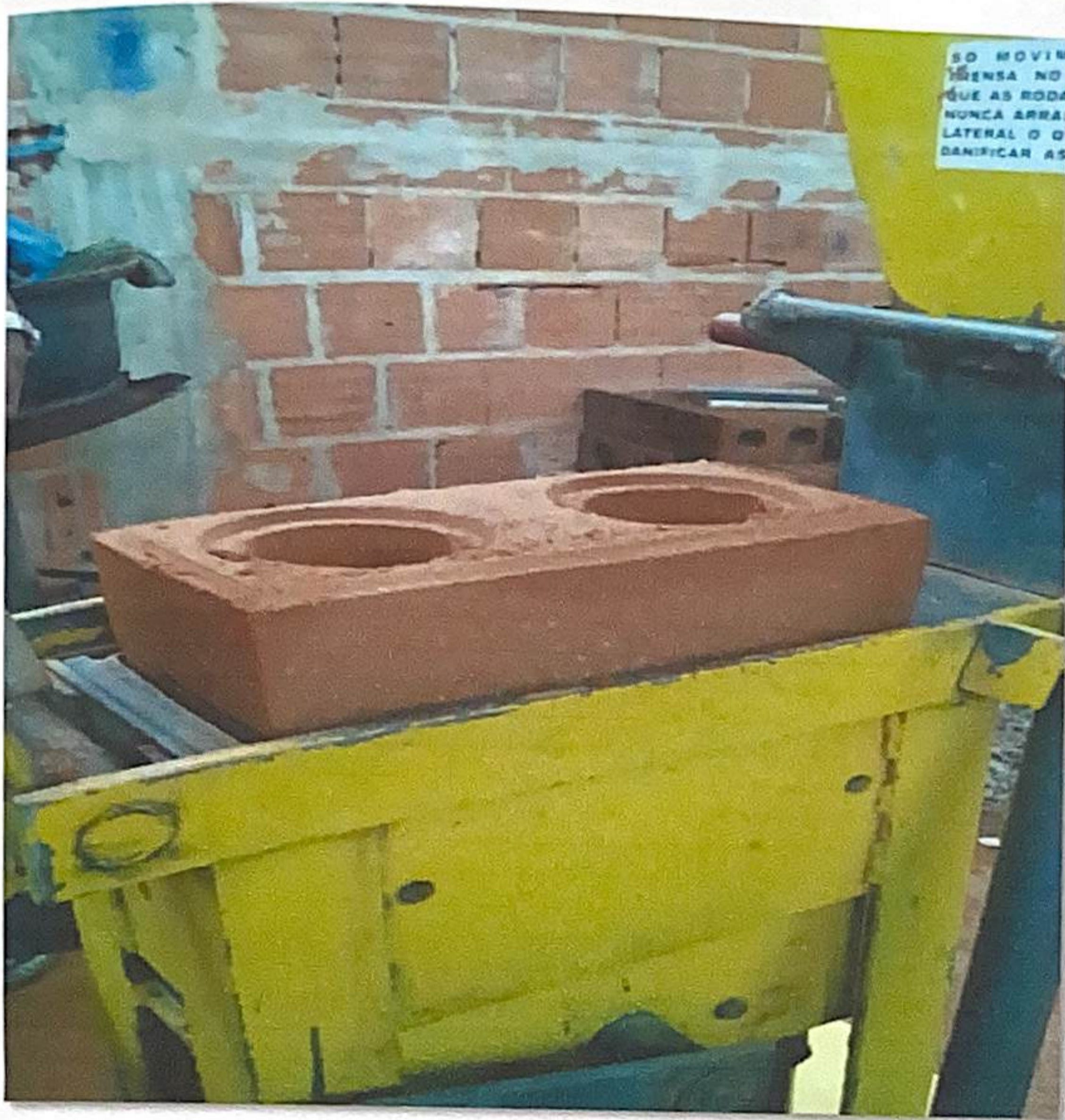
Figura 06- Prensa manual do tijolo ecológico do Senhor Thiones.
