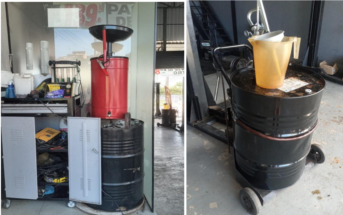
Figura 8: Acondicionamento de óleos lubrificantes
