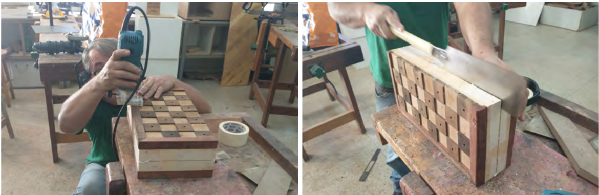
Figura 109 e 110: Utilização da Tupia refileadora para suavizar arestas e Serrote Japonês para dividir a caixa.
