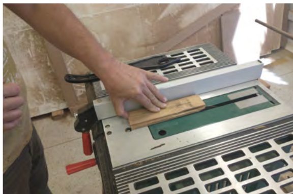
Figura 85: Retirada das bordas dos tacos e adequação de tamanho para 5 cm na Esquadrejadeira com Serra Circular.
