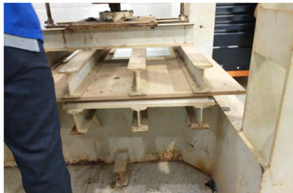
Figura 51, 52 e 53: Processo de colagem da base do tabuleiro e utilização de Prensa Hidráulica para auxiliar na fixação.
