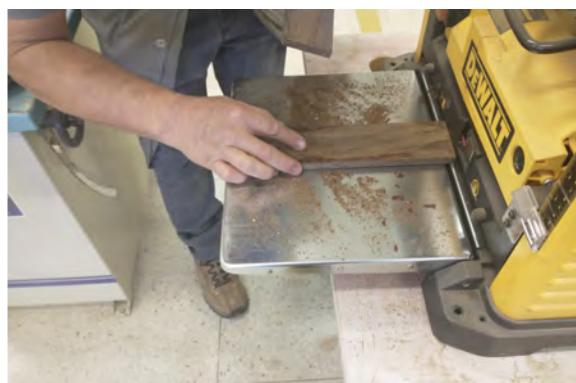
Figura 83: Adequação dos tacos escuros em 1,5 cm de espessura no desengrosso.
