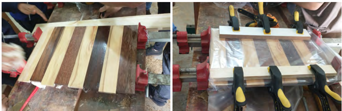
Figura 41 e 42: Fixação das peças por meio de sargentos e grampos.
