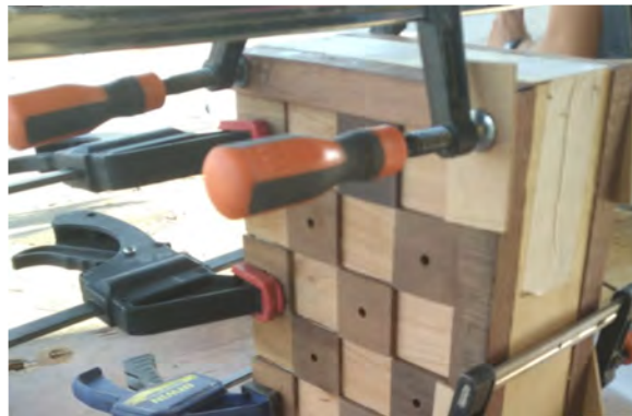
Figura 106: Processo de Colagem da moldura e caixa com auxílio de grampos e sargentos para fixação.
