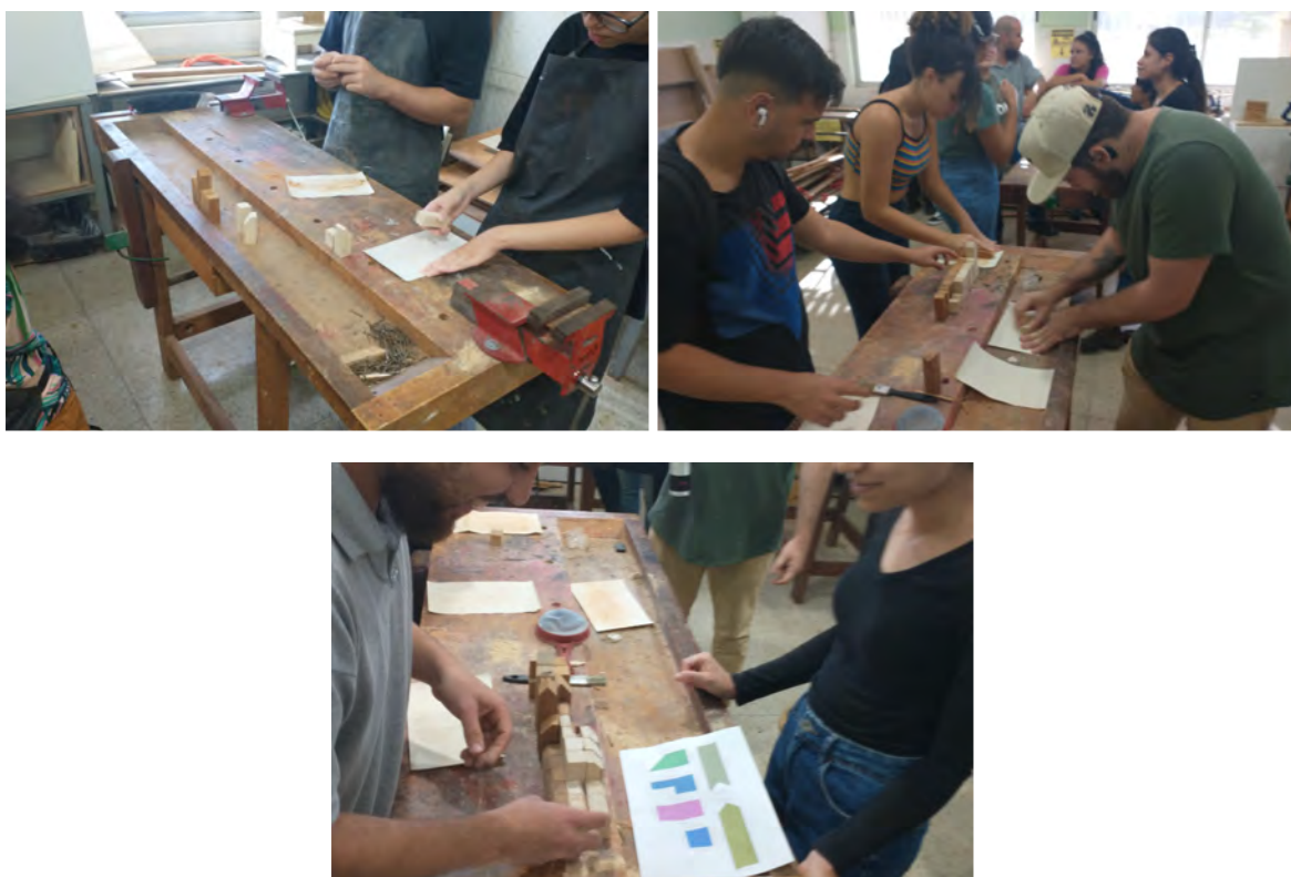
Figuras 73, 74, 75: Processo de acabamento (lixamento) das peças de xadrez
