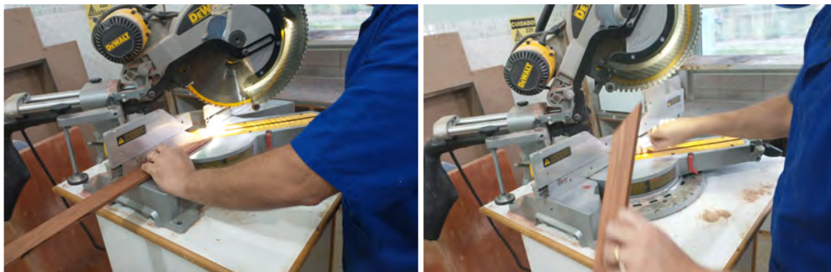
Figura 57 e 58: Corte de 45° (Meia Esquadria) feita na Serra Circular.
