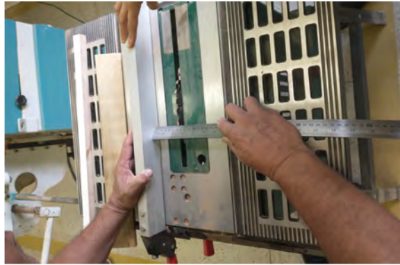
Figura 32: Ajuste da máquina Esquadrejadeira para a medida de 5,5 cm de dimensionamento.
