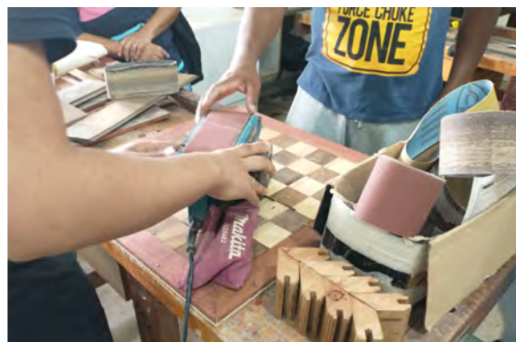
Figura 66: Processo de acabamento utilizando Lixadeira de Cinta Manual.
