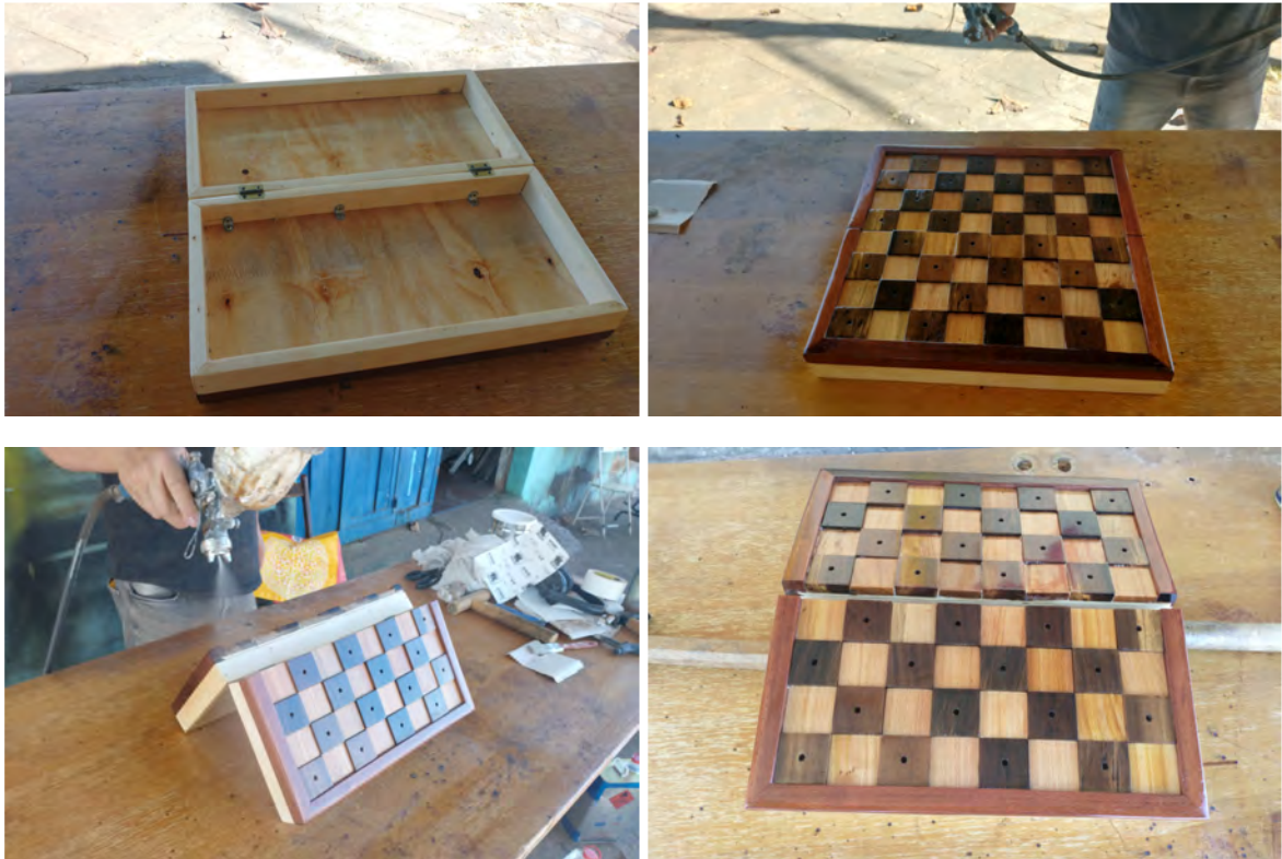
Figura 121, 122, 123 e 124: Processo de acabamento pela aplicação do produto Seladora com auxílio de Pistola Pneumática.
