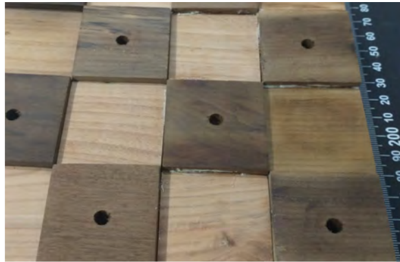
Figura 101: Expansão do Adesivo PU entre as faces laterais das casas.
