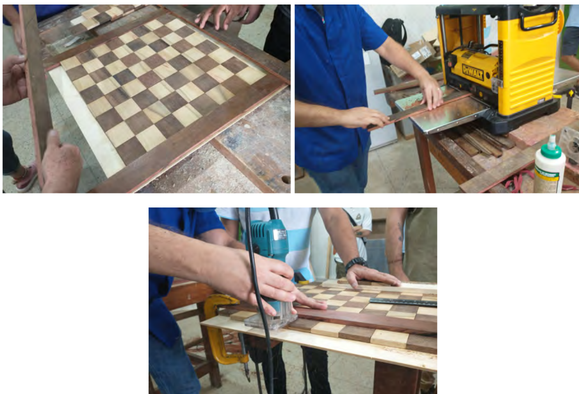
Figura 54, 55 e 56: Madeira de Angelim Vermelho, sendo adequada na espessura de 1,5 cm no Desengrosso. Depois foi feita a retirada de rebarbas pela Tupia refiladora manual.
