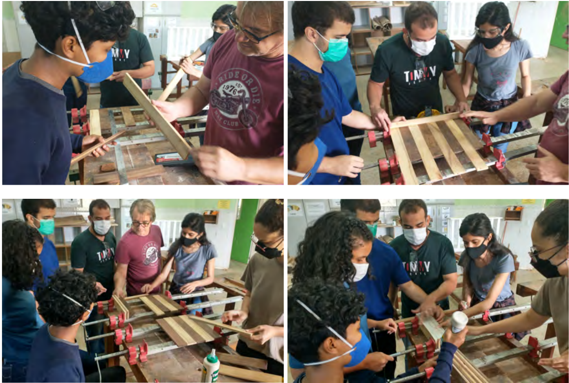
Figura 37, 38, 39 e 40: Processo de colagem das faces laterais das peças pelo adesivo PVAc.
