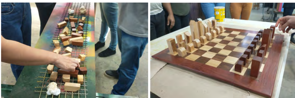
Figura 78 e 79: Aplicação do produto Seladora no tabuleiro.
