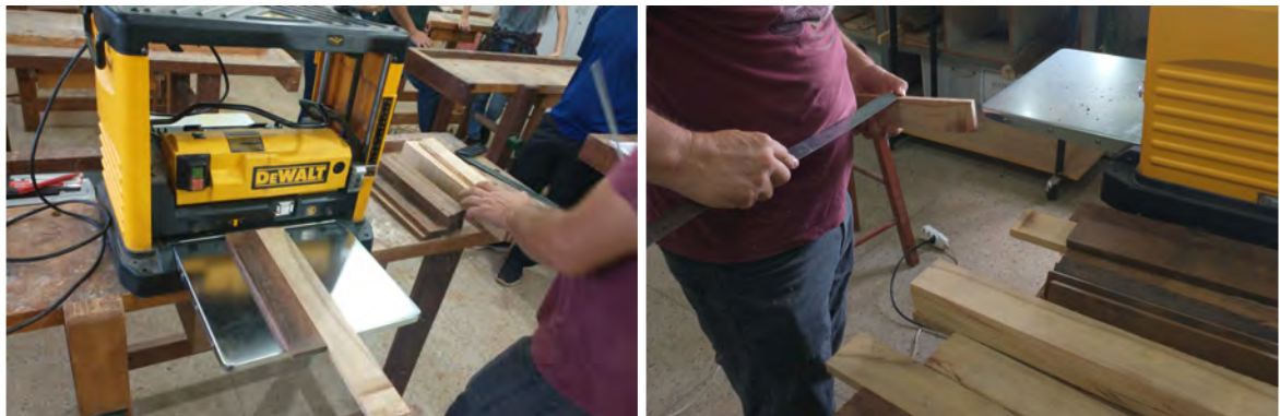
Figura 35 e 36: Realização do adequamento em 1,5 cm de espessura das peças.
