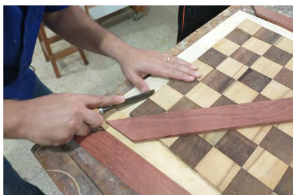
Figura 59: Ajustes realizados na lateral do tabuleiro por meio de Formão.
