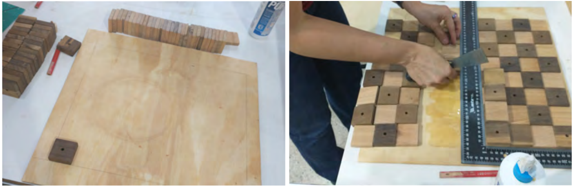
Figura 99e 100: Organização e processo de colagem de 32 casas do tabuleiro alinhados por esquadro.
