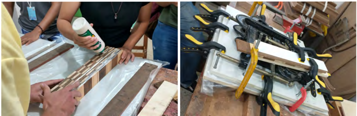
Figura 47 e 48: Junção lateral das peças pelo adesivo PVAc e fixação por meio de grampos para obter um tabuleiro (sem moldura e fundo),
