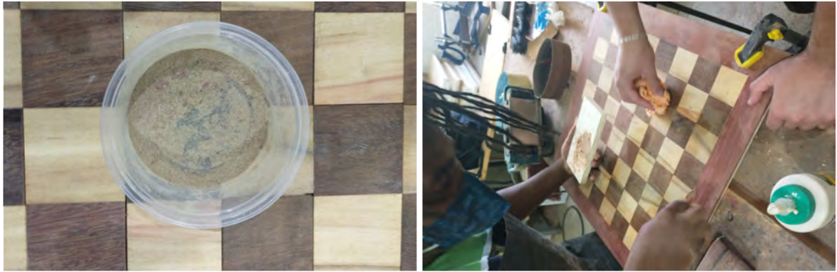
Figura 62 e 63: Pó de madeira mesclado com adesivo PVAc para o preencher cavidades e espaços
