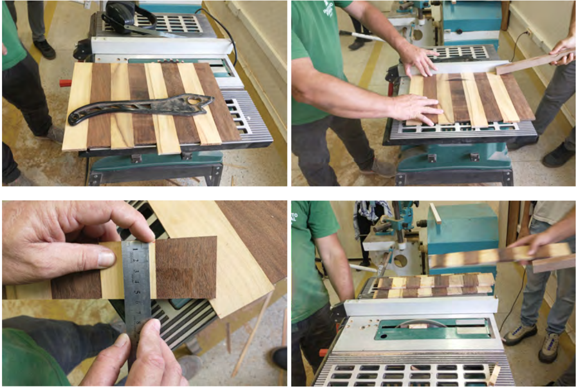
Figura 43, 44, 45 e 46: Adequamento pela Serra Circular das peças para obter casas alternadas de 5,5 cm x 5,5 cm.
