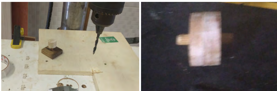
Figura 97 e 98: Gabarito para furar as casas escuras na Furadeira de Coluna e teste de encaixe de cavilha.
