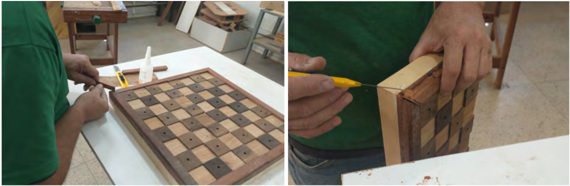
Figura 111 e 112: Foi feita a aplicação de cianoacrilato com pó de madeira para preencher espaços e falhas na madeira.
