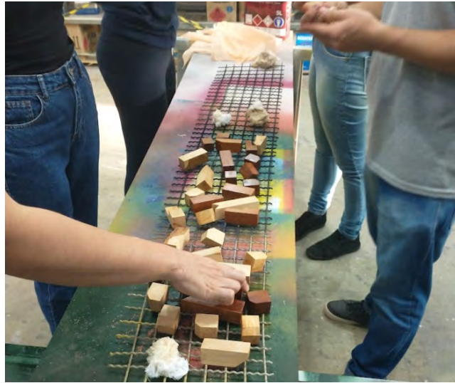
Figura 1: Alunos aplicando produto de acabamento (seladora) nas peças de xadrez.
