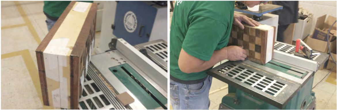
Figura 107 e 108: Cavidade de 3mm realizada no meio da caixa por Serra circular.
