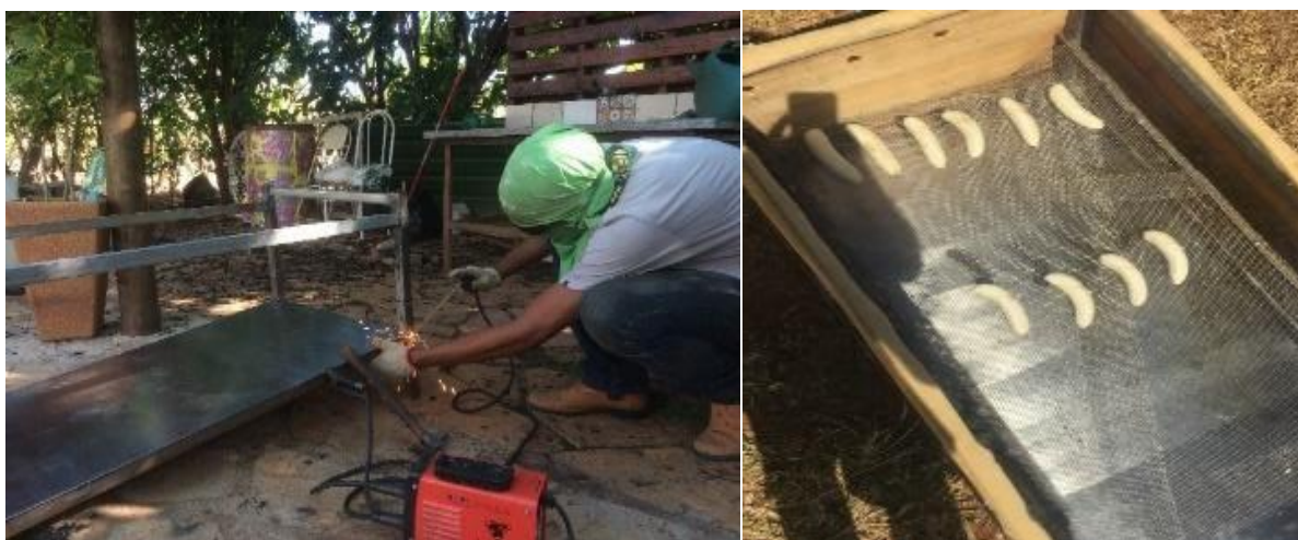
Figura 2 - Processo de construção do desidratador e bandeja com tela de alumínio, respectivamente
