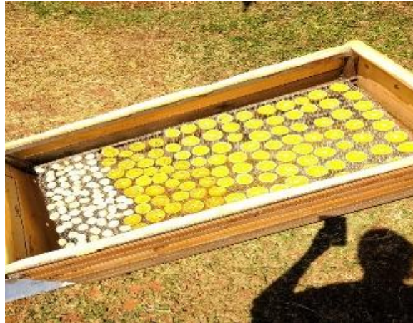
Figura 3 - Câmara de secagem das frutas para desidratação
