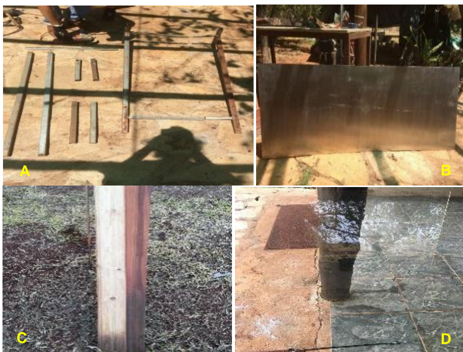
Figura 1 - Materiais utilizados na construção do protótipo do desidratador: a) varões, b) placa de inox, c) madeira de cedrinho, d) peça de vidro
