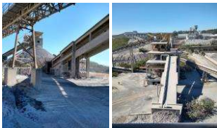
Fig. 5: a) Chegada de pedras da mina, b) britadores de brita 2, 1, pedrisco e pó (cermim).
