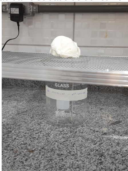
Figura 9 - Amostra de sorbet de abacaxi sobre tela de arame e b quer para avalia  o da velocidade de derretimento
