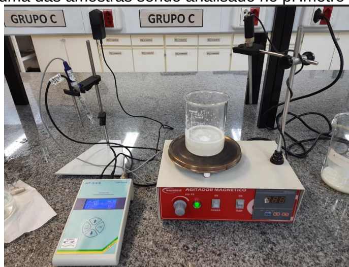
Figura 8 - pH de uma das amostras sendo analisado no pHmetro de bancada
