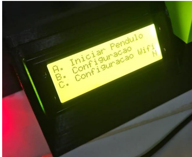
Figura 9: Tela inicial do sistema, mostrando o menu principal com as opções: A. Iniciar o pêndulo, B. Configurações e C. Configurar Wi-Fi.
