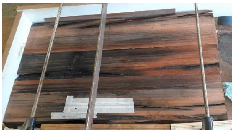
Figura 11 – Processo de colagem das peças para a fabricação do tampo da mesa lateral e travamento com grampos tipo “C” de marcenaria.
