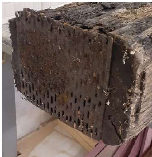
Figura 08 – Detalhe da grade metálica no dormente de estrada de ferro coletado para a fabricação do tampo.
