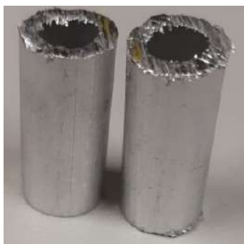
Figura 18 - Peça de elevação para a mesa lateral, fabricada em tubo de alumínio de 10 mm de diâmetro.
