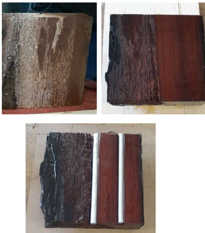
Figura 07 –Teste preliminar da utilização da resina epóxi na madeira para a fabricação do tampo, onde: à esq. a madeira recém cortada; ao centro a madeira após a aplicação da resina epóxi; e à dir. a utilização do perfil de alumínio.
