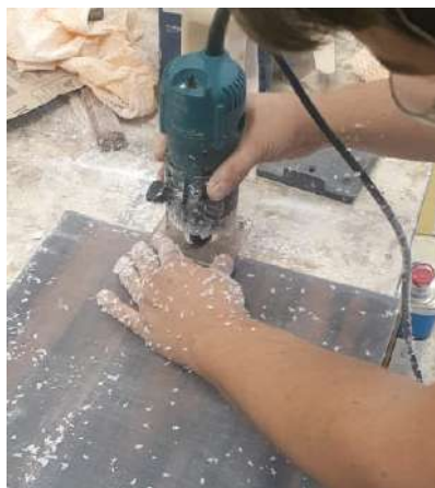
Figura 14 – Acabamento da borda (arestas) do tampo da mesa com a utilização de tupia laminadora e fresa de desquinar.
