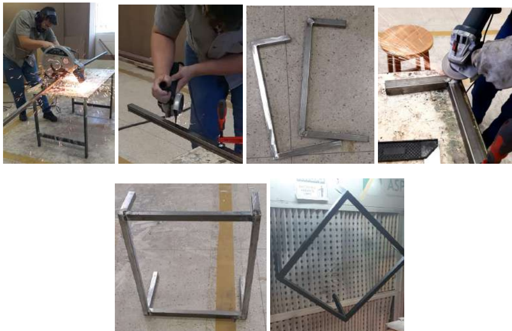
Figura 17 - Processo de fabricação da base: corte em serra meia esquadria, angulação com esmerilhadeira, desbaste da solda e aplicação da pintura com esmalte sintético.
