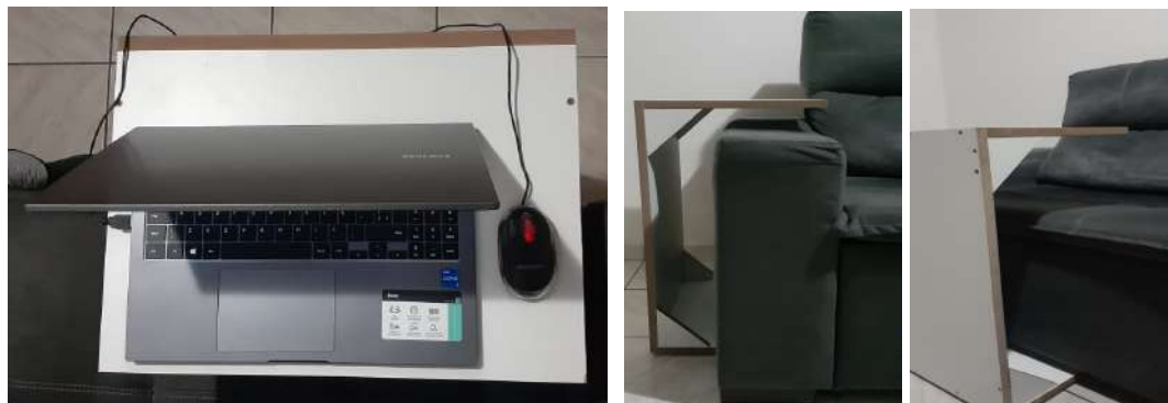
Figura 02 – Modelo volumétrico fabricado previamente para a análise ergonômica do projeto da mesa lateral, onde: à esquerda: vista superior do modelo volumétrico com a utilização do notebook; à direita: vista lateral e em perspectiva para modelo em uso como mesa lateral.
