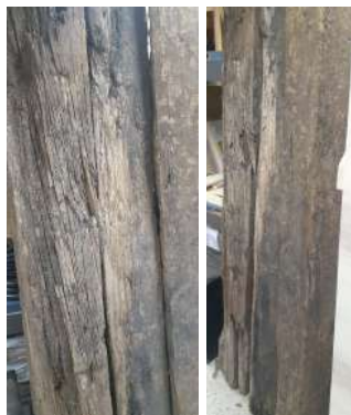
Figura 01 - Dormentes de estrada de ferro coletados para a fabricação do tampo da mesa, evidenciando a condição ruim da madeira, com rachaduras e desgastes causados pelas intempéries.
