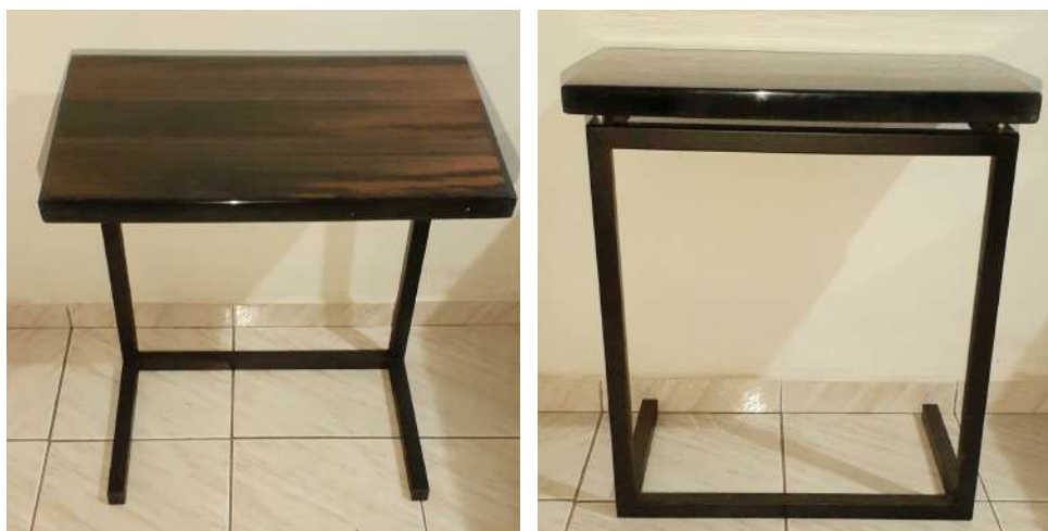
Figura 19 - Mesa lateral fabricada com dormite de estrada de ferro após a montagem das peças, tampo, base e peças de elevação.
