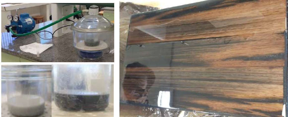
Figura 16 – Utilização de bomba de vácuo para a eliminação das bolhas durante a preparação da resina epóxi e fabricação do tampo da mesa.
