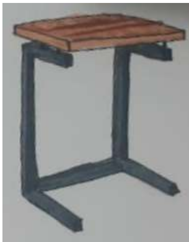
Figura 05 - Alternativa escolhida após os desenhos à mão livre, por ser o formato mais simples e que permitiria a valorização do tampo com as imperfeições da madeira.
