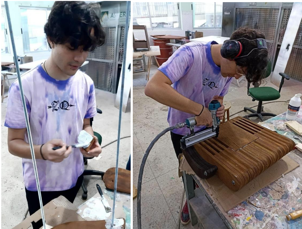
Figura 16 - Colagem das peças com adesivo PVA e pinos.
