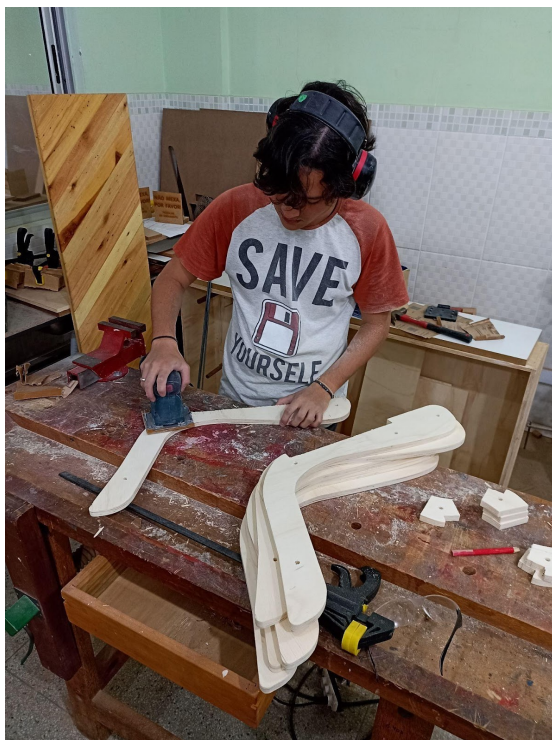
Figura 14 - Processo de lixamento das peças da cadeira com preparação para acabamento final.
