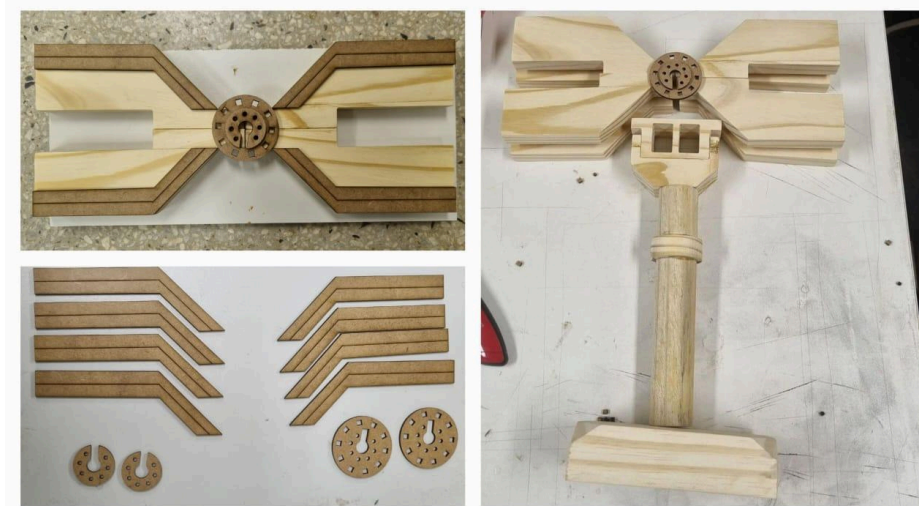
Figura 10: Separação das peças cortadas à Laser e o processo de pré-montagem das peças da luminária.
