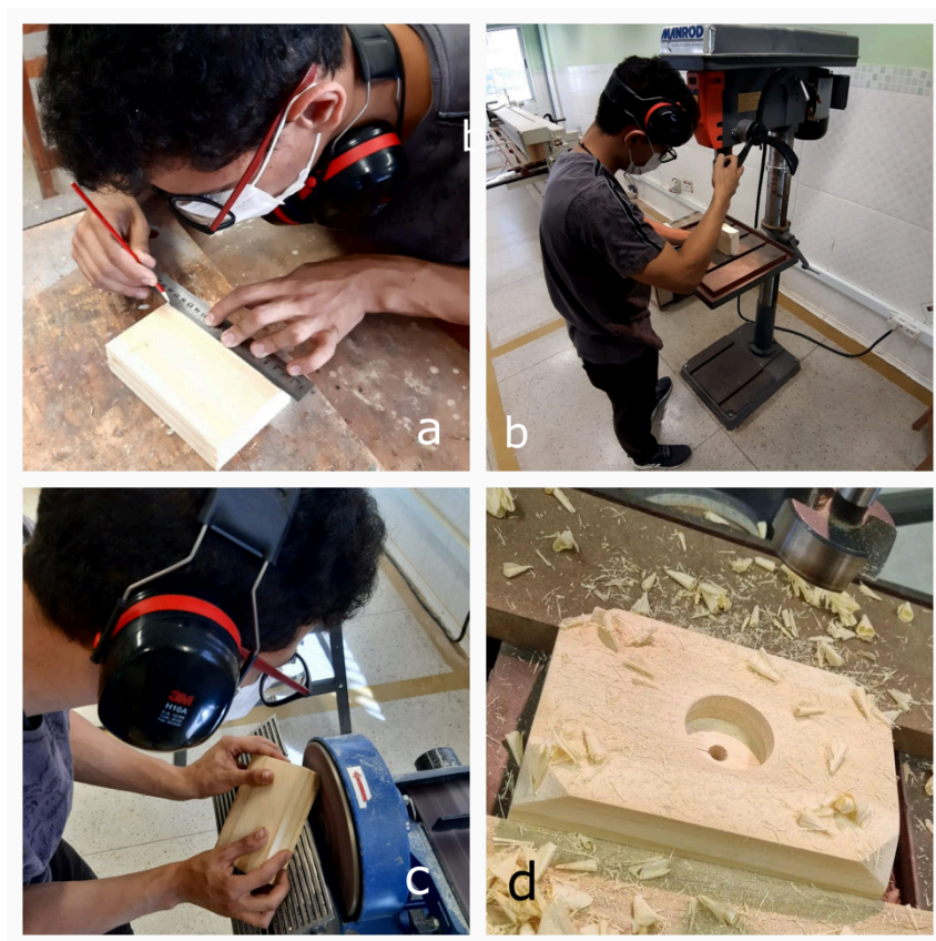
Figura 7: Momentos de criação da peça Base, a): Demarcação dos chanfros e furos; b) Realização dos furos para passagem do fio de alimentação de energia; c): Execução dos chanfros na lixadeira de disco; d): Furo realizado para o posicionamento da peça “cabo”.
