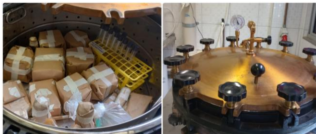
Figura 11 - (A) materiais para o ensaio biológico dentro da autoclave.(B) Autoclave fechada e em processo de esterilização dos materiais.
