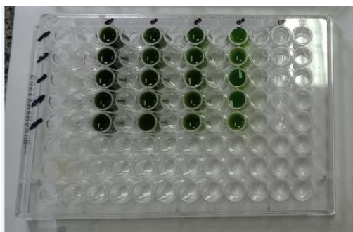
Figura 10 - Microplaca de PCR de 96 poços preenchida com as soluções de extrato de A. brasiliense e com os náuplios de A. salina .
