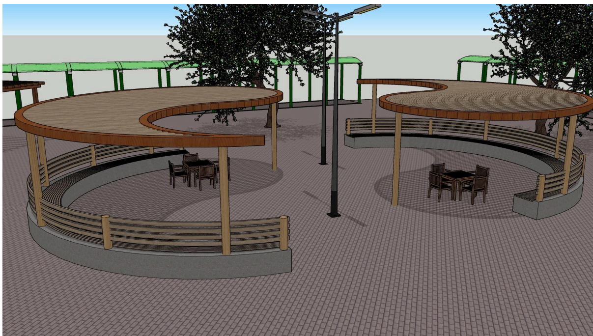
Figura 17 – Análise de sombreamento às 12h, durante o solstício de verão (21 de dezembro), com o pergolado proporcionando boa proteção contra a radiação solar e garantindo conforto térmico. (Fonte: Elaborada pela autora, 2025.)
