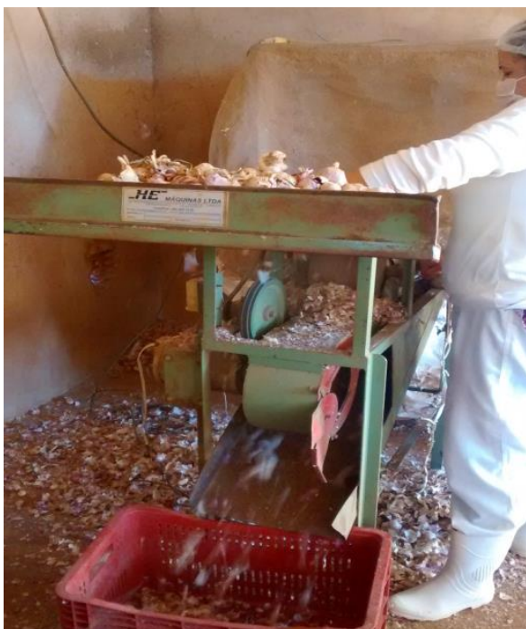
Fig. 11- Máquina debulhadeira de alho.
