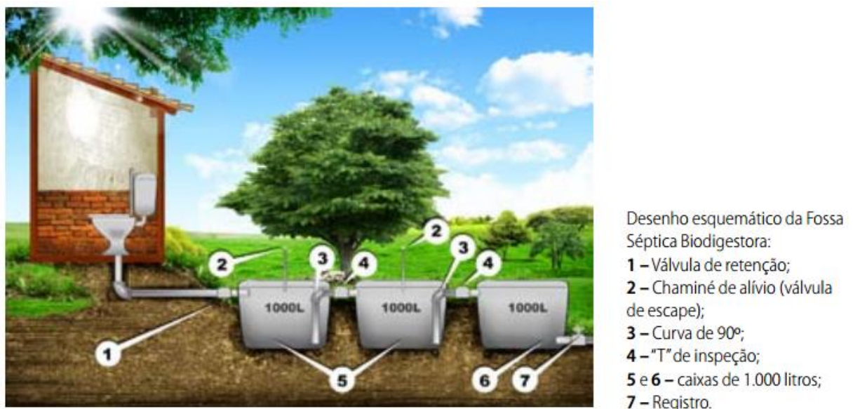
Figura 10: Desenho esquemático da Fossa Biodigestora. Fonte: Fundação Banco do Brasil, 2010.
