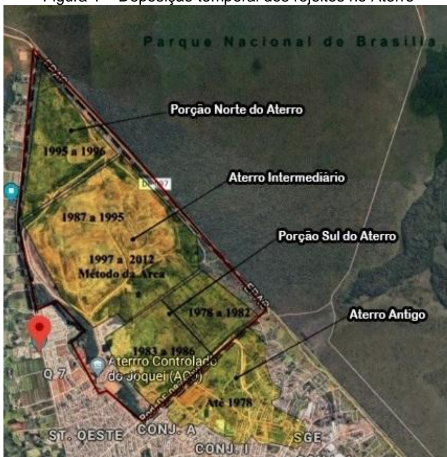
Figura 1 – Deposição temporal dos rejeitos no Aterro
