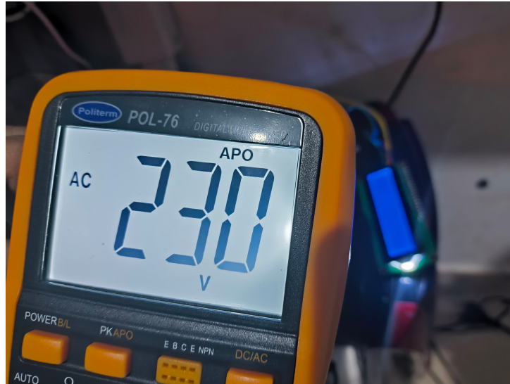
Figura 4.8 – Leitura do Multímetro no dispositivo versão 3.0.
