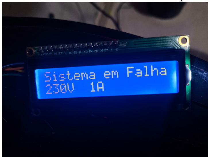
Figura 4.9 – Leitura do Sensor de Tensão Calibrado no Dispositivo Versão 3.0.
