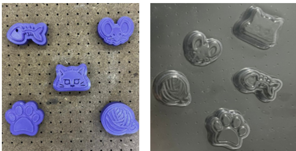
FIGURA 27 - Resultado da termoformagem, em que: à esquerda há a posição vertical dos moldes; e à direita, a chapa termoformada selecionada com os formatos dos moldes na diagonal.
