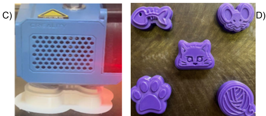
FIGURA 21 - Sistema de impressão: na (A) é apresentado o material PLA em filamentos; (B), a máquina de impressão 3D; (C), o processo de impressão dos moldes; e (D), o resultado da impressão dos moldes.
