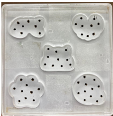
FIGURA 22 - Suporte termoformado, em que: (A), é a modelagem do suporte; a (B), molde físico montado; E (C), o processo de furação concluído.
