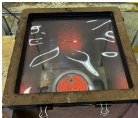
FIGURA 24 - Quadro com chapa termoplástica, em que à esquerda, a chapa foi fixada com um quadro de MDF e grampos; e à direita o conjunto do quadro está sendo aquecido pelo sistema de termoformagem.
