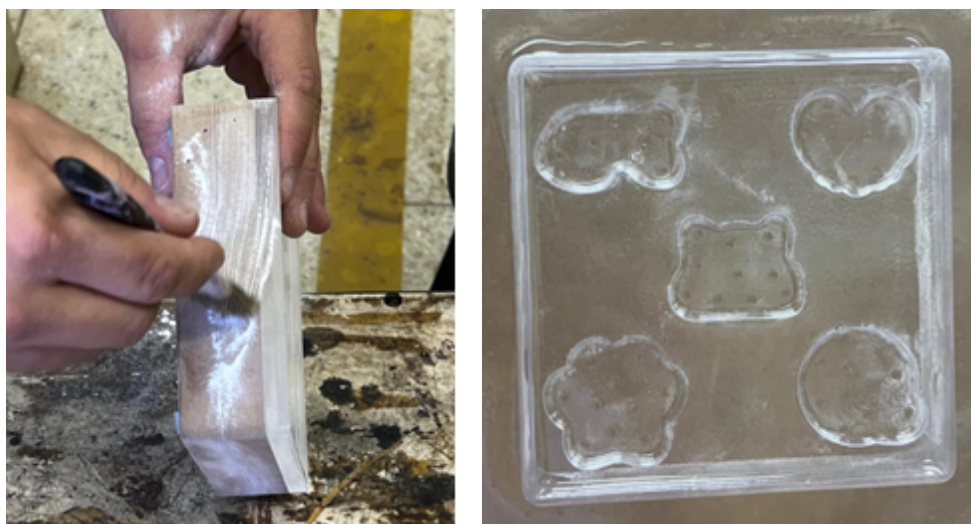
FIGURA 29 - Molde da termoformagem, em que: à esquerda há a aplicação do talco no molde do suporte; e à direita, o suporte termoformado concluído.
