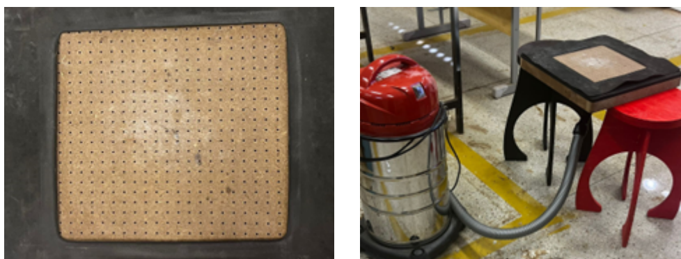
FIGURA 25 - Sistema de sucção da termoformagem, em que: à esquerda há imagem da base de MDF perfurada; e à direita a imagem do sistema de sucção montado com o aspirador fixado abaixo da base.
