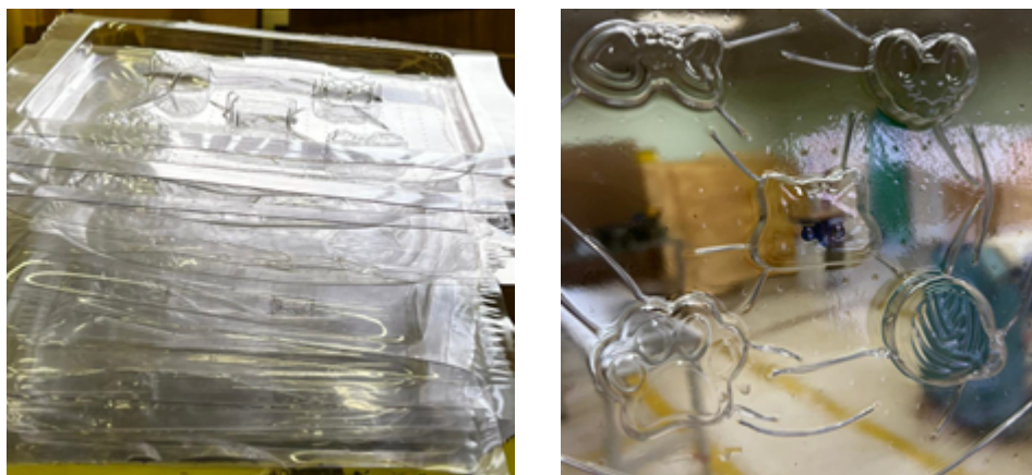
FIGURA 26 - Testes da termoformagem, em que: à esquerda há a chapa termoformada com fissuras; e à direita, o conjunto dos testes de termoformados empilhados.
