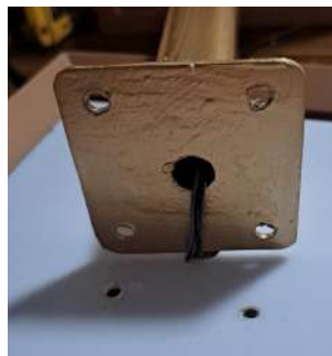
Figura 47 - Imagem dos furos feitos na luminária
