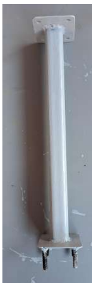
Figura 42 - Barra de ferro após a aplicação do primer
