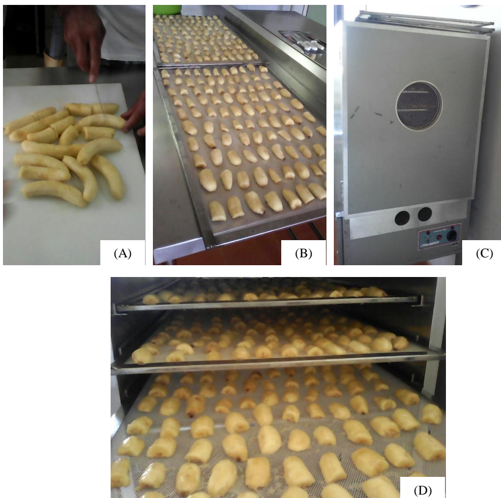
Figura 3. Processamento da banana desidratada em laboratório. A) banana in natura, B) separação da amostra, C) modelo do secador tipo cabine, D) realização da secagem. Fonte: MACIEL; SILVA (2016)
