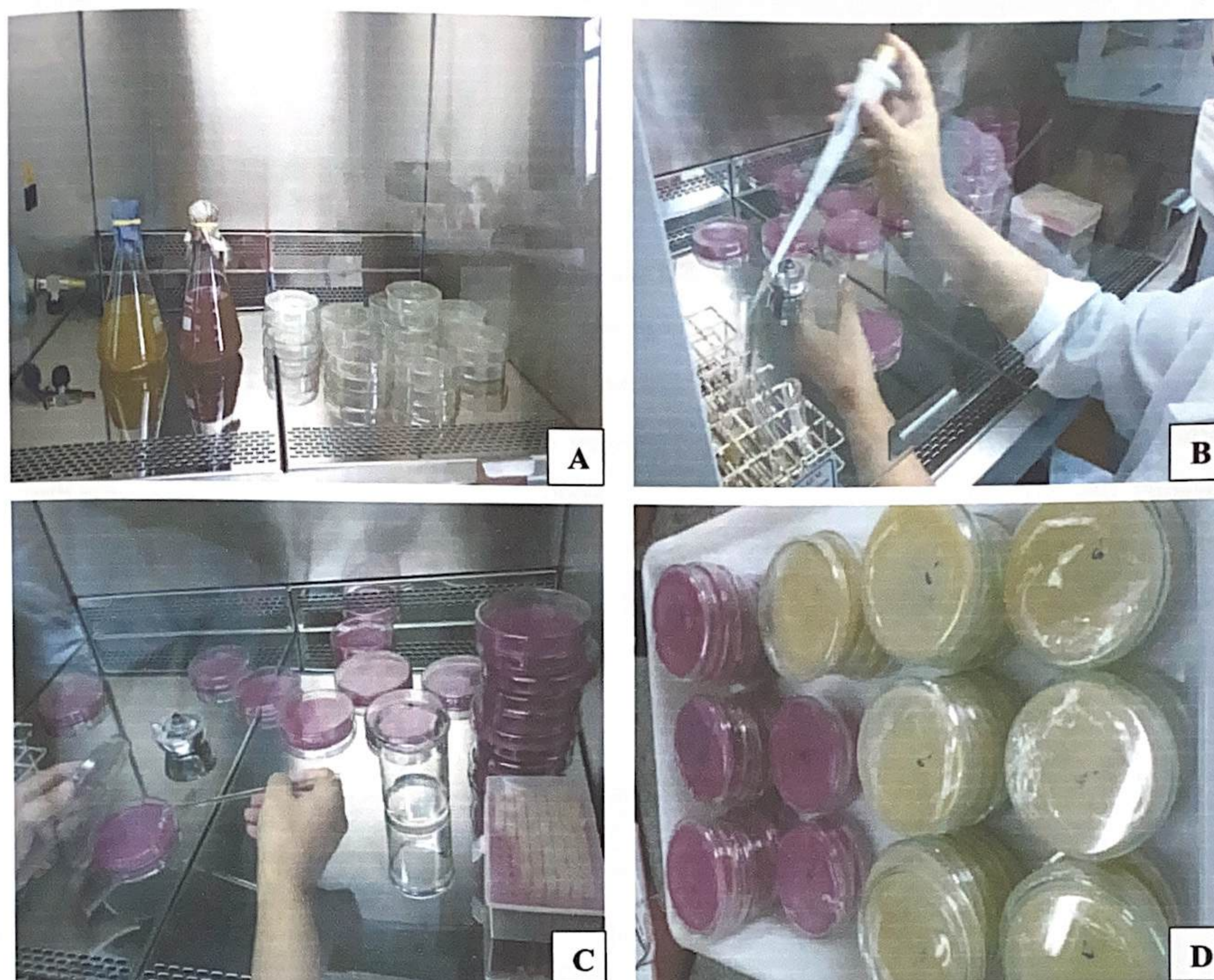
Figura 11- Ameio de cultura para bactérias e fungos (totais e solubilizadores de fosfato de cálcio), B semeando microrganismos nas placas de Petri, C espalhando microrganismos com a alça de Drigalski, D placas prontas para incubarna estufa 28°C. (Fonte: Andréia e Arolda, 2016).
