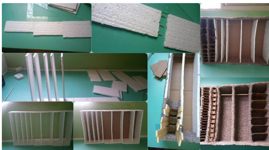
Figura 59 - Construção da maquete
