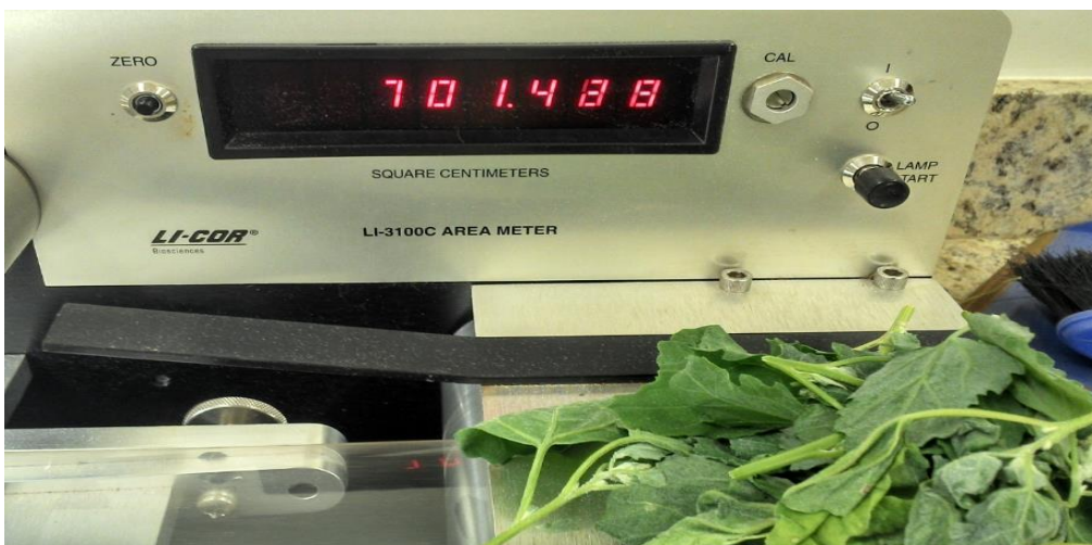
Figura 5- Aparelho medidor de área foliar.
