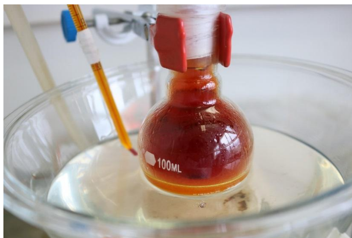
Figura 12. Detalhe do aparato para a síntese do benzil.
