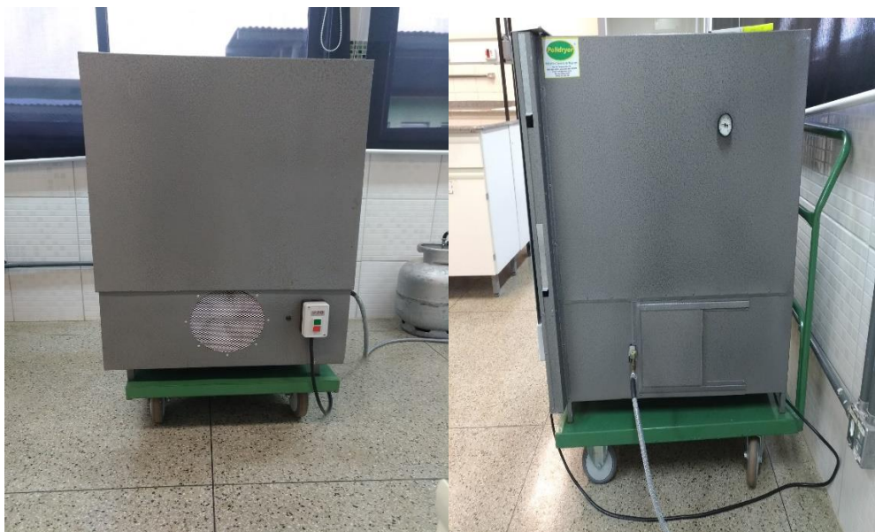
Imagem 1: Forno de secagem industrial a gás GLP.
