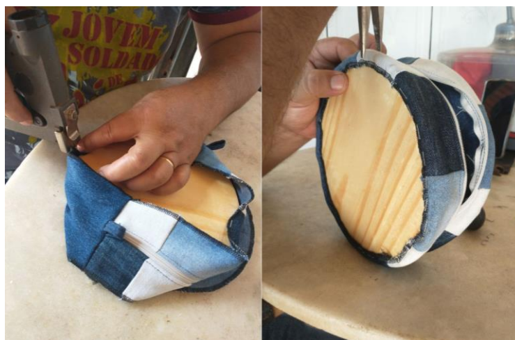
Figura 42 - Grampeando a bolsa e reforçando o aperto com alicate
