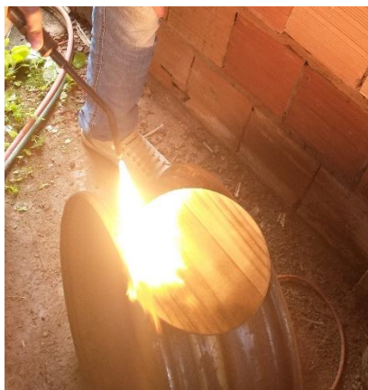
Figura 32 - Aplicação da técnica Shou Sugi Ban
