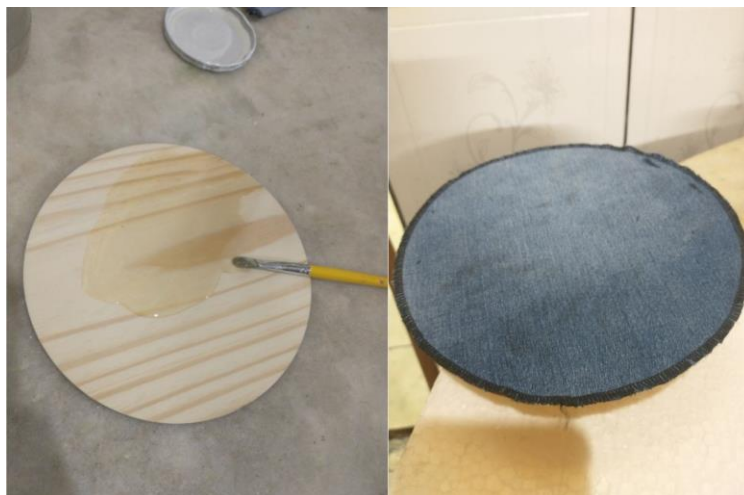
Figura 41 - Aplicação da cola e do revestimento interno
