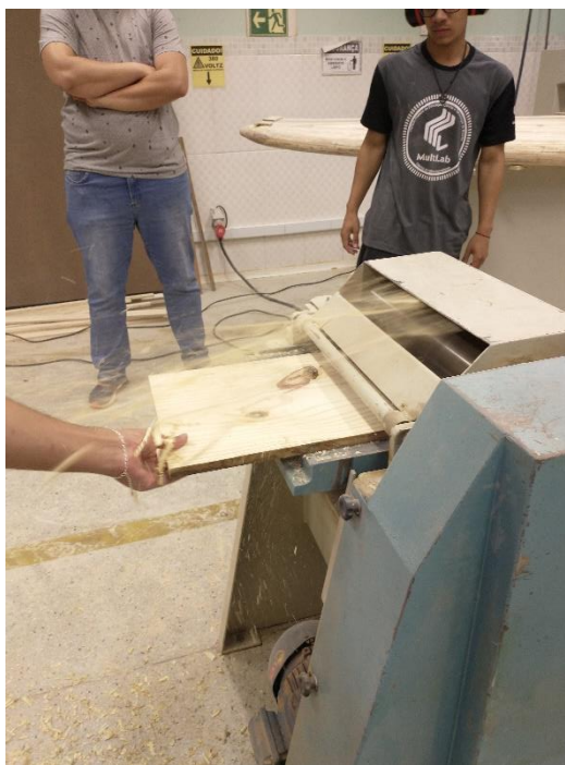
Figura 27 - Tábua passando pela plaina desengrossadeira
