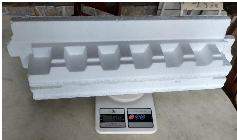
Figura 20 - Isopor sendo medido para a resina menos viscosa
