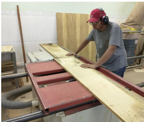
Figura 26 - Tabua de pinus sendo cortada na esquadrejadeira
