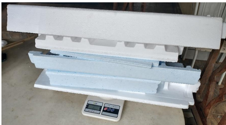
Figura 21 - Isopor sendo medido para a cola
