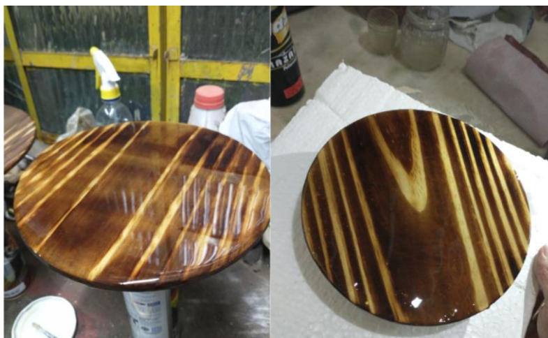
Figura 35 - Discos resinados esperando o tempo de cura
