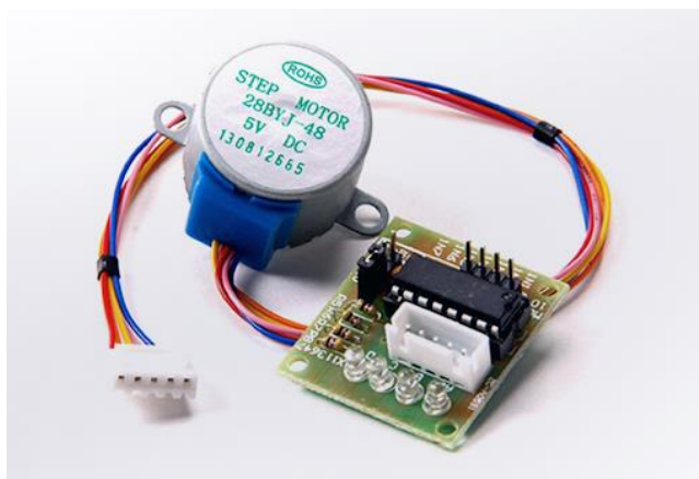
Figura 6 – Exemplo motor de passo 28BYJ-48 com driver ULN2003
