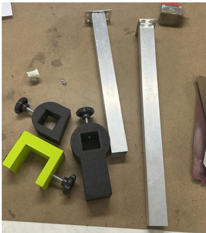
Figura 14 – Peças base impressas em 3D e Tubo de alumínio com chapas soldadas
