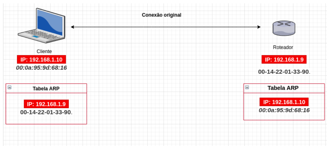
Figura 5.30 Conexão entre cliente e roteador.
