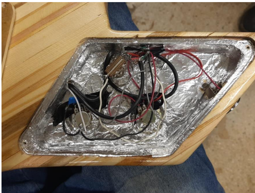
Figura 27 - Instalação da parte elétrica com 1 volume, 1 tom e 2 humbuckers
