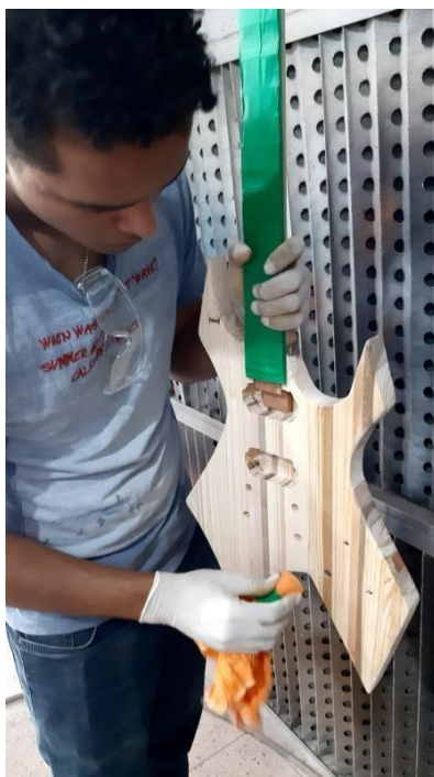
Figura 23 - Aplicação da seladora no corpo
