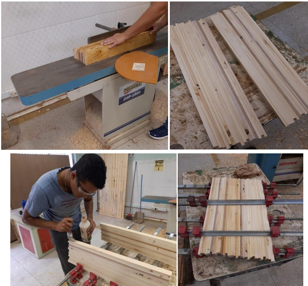
Figura 10 - Aplainamento e colagem do bloco de madeira
