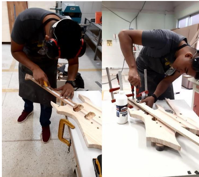
Figura 22 - Colagem do tensor e da escala no braço
