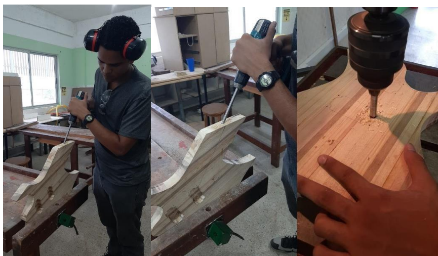
Figura 15 - Rebaixo e perfuração no corpo da guitarra
