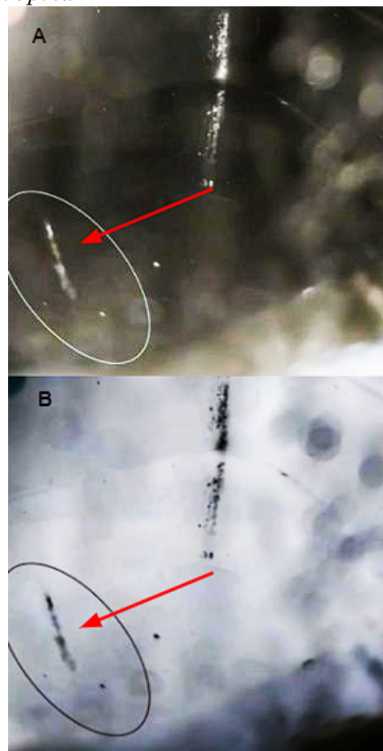
Figura 4.8 – A) Rastro deixado por uma partícula de baixa energia. B) Negativo do rastro deixado por uma partícula de baixa energia.
