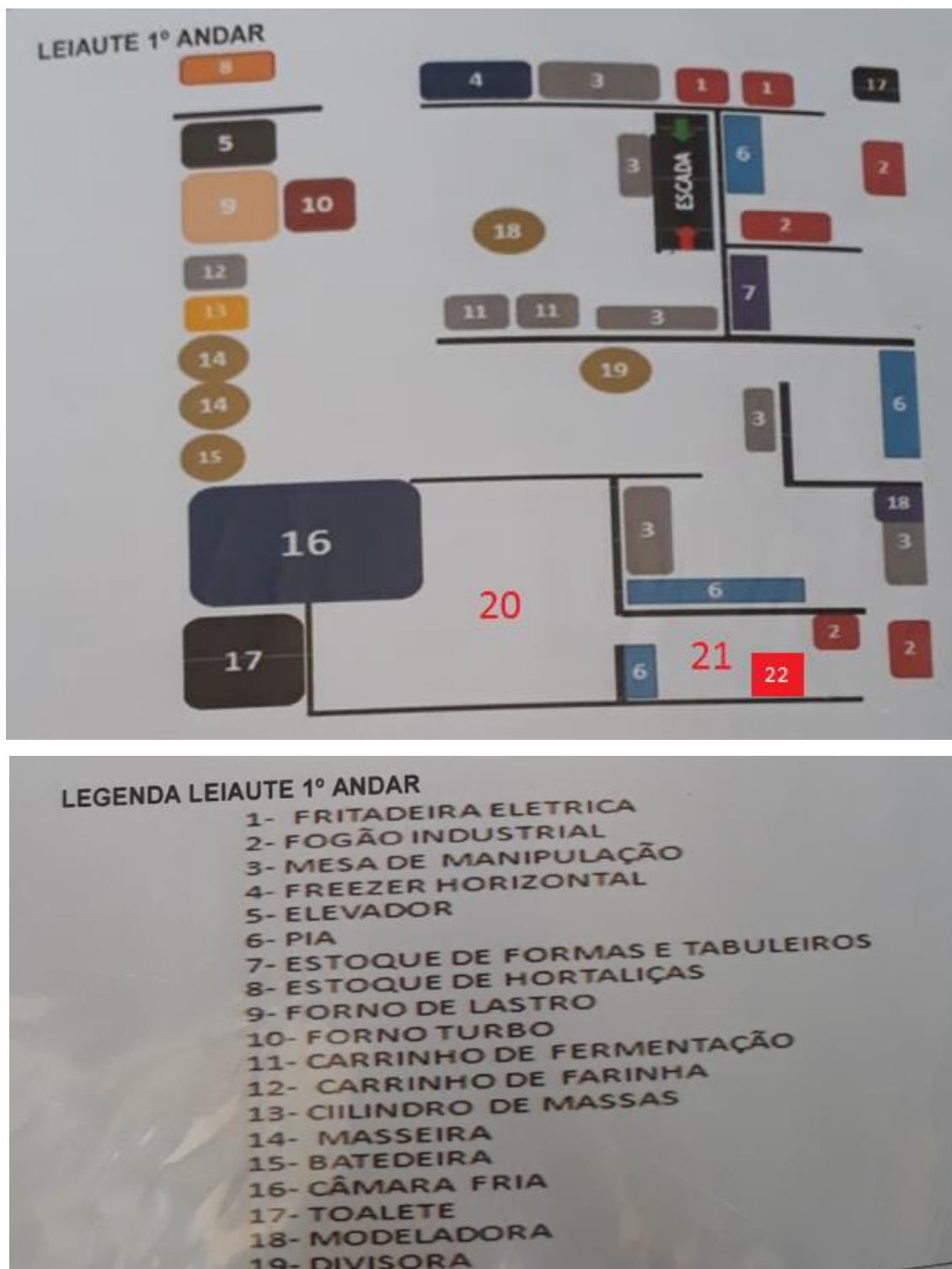
Figura 1 – Layout do primeiro andar da padaria pesquisada, com a inclusão dos itens 20, 21 e 22, referentes à, respectivamente, área para refeitório, área de preparo das refeições para os funcionários e refrigerador.
