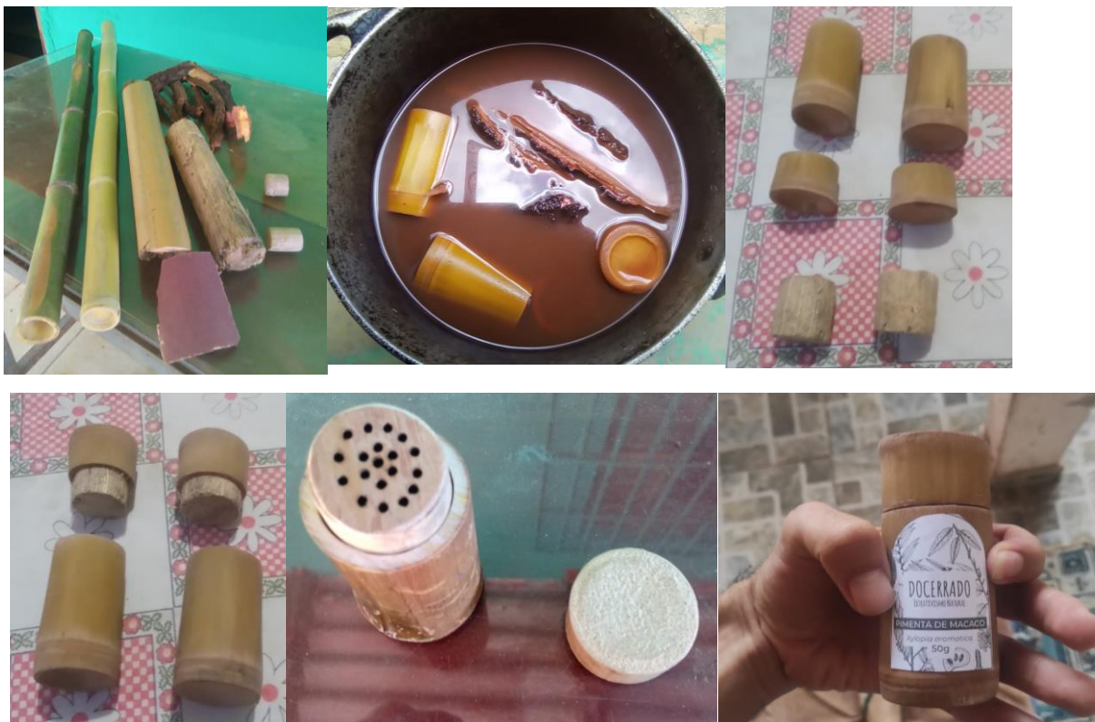
Figura 6: Seguindo as imagens da esquerda para direita e de cima para baixo temos: antiga embalagem de plástico; materiais usados na confecção da nova embalagem; tratamento de imersão em barbatimão para cura do bambu; 3 partes da embalagem em bambu e buriti;
