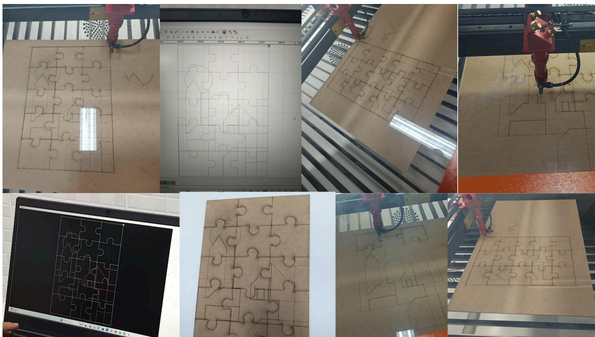
Figura 7 – Máquina de corte a laser utilizada no processo de fabricação do quebra-cabeça.
