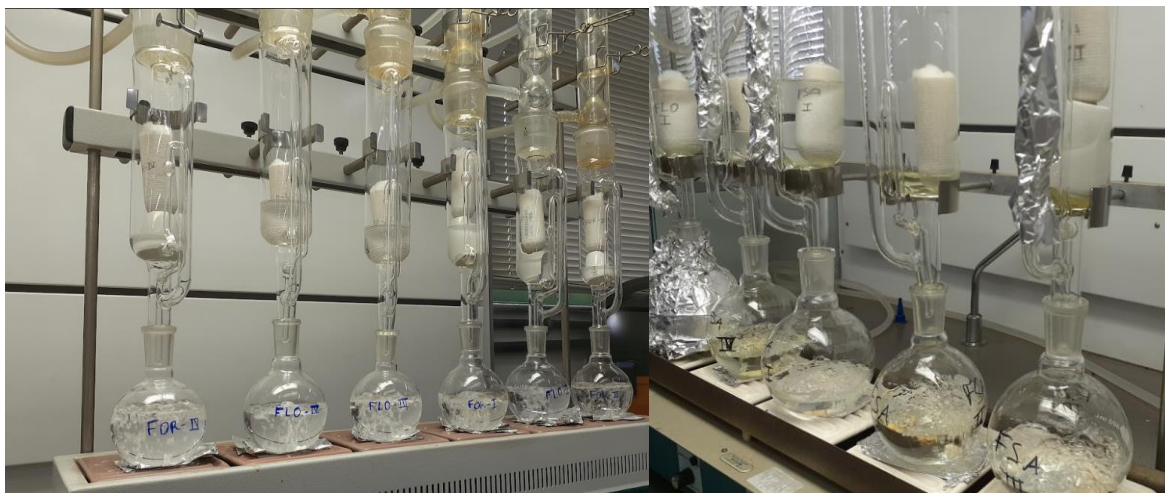
Figura 10: Extração de lipídios pelo método de Soxhlet
