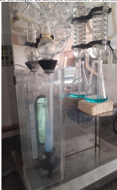
Figura 9: Etapa de destilação da amostra utilizando um destilador de nitrogênio
