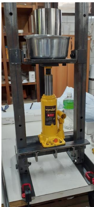
Figura 13: Prensa manual desenvolvida utilizando um macaco hidráulico e suporte de aço inox.
