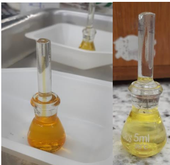
Figura 16 - Picnômetros utilizados na análise densidade relativa.
