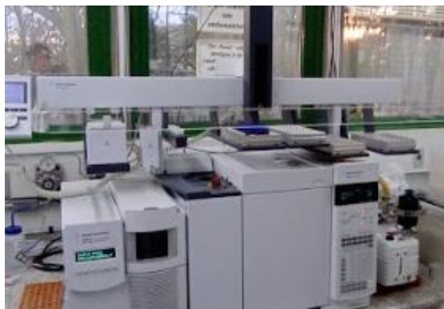
Figura 17 - Cromatógrafo gasoso com injetor automático, acoplado ao espectrômetro de massa.
