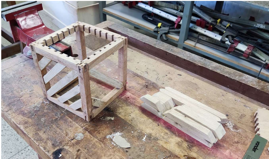
Figura 15 - Montagem da caixa com treliça da luminária.
