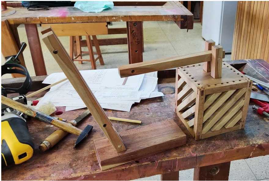
Figura 17: Montagem do “braço” da luminária.
