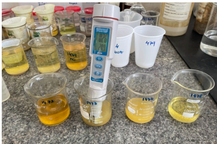
Figura 4 - Análise de pH da amostra de bioflocos
